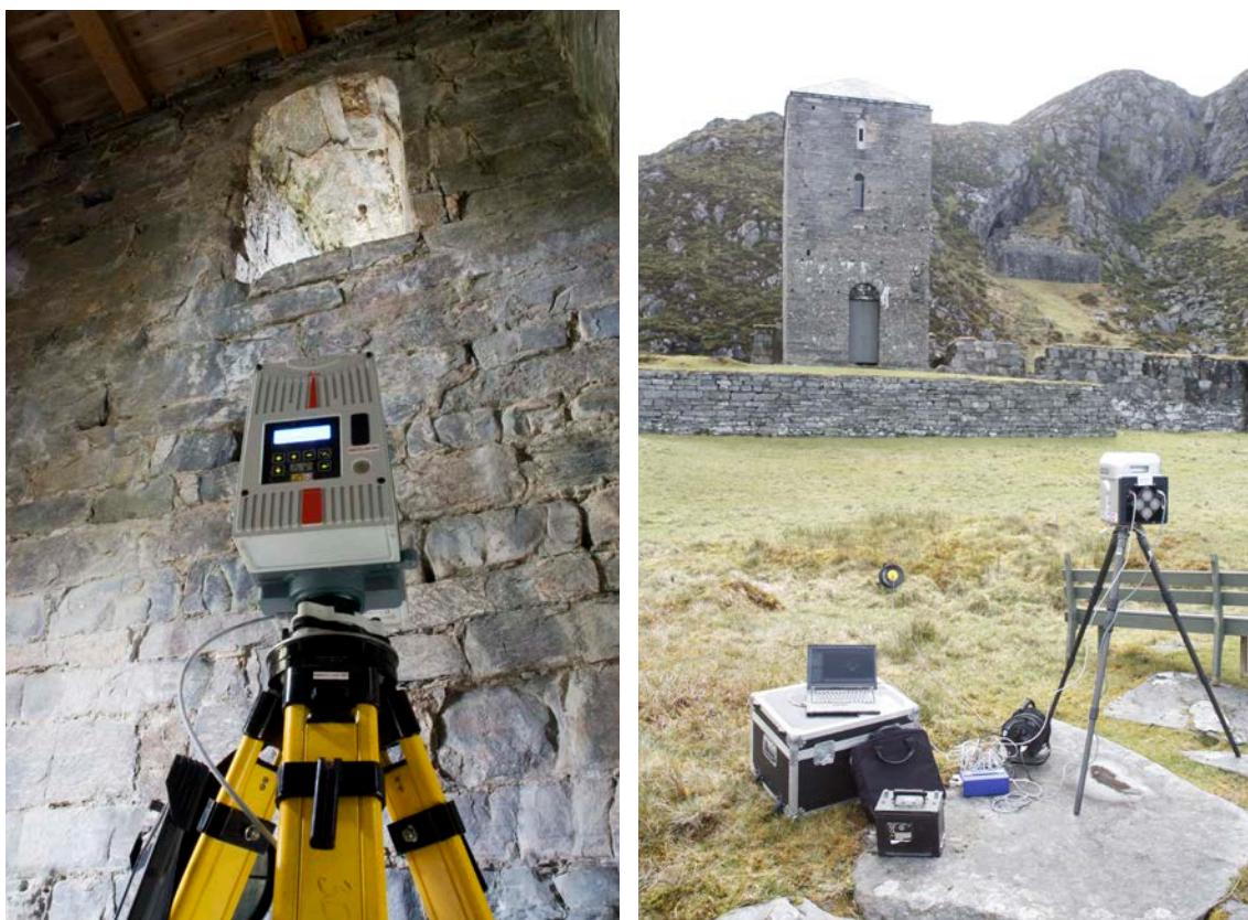
Figur 3 – Til venstre: Leica HDS6000 faseskanner. Til høyre: Trimble GS200 pulsskanner Foto: NIKU/Knut Paasche
