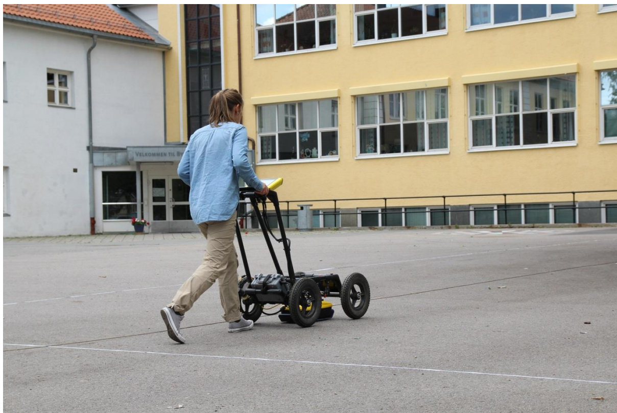
Figur 2 - Sensors & Software Noggin 500 Plus enkeltkanalssystem i bruk ved Bygdøy skole. Foto: LG/NIKU.
