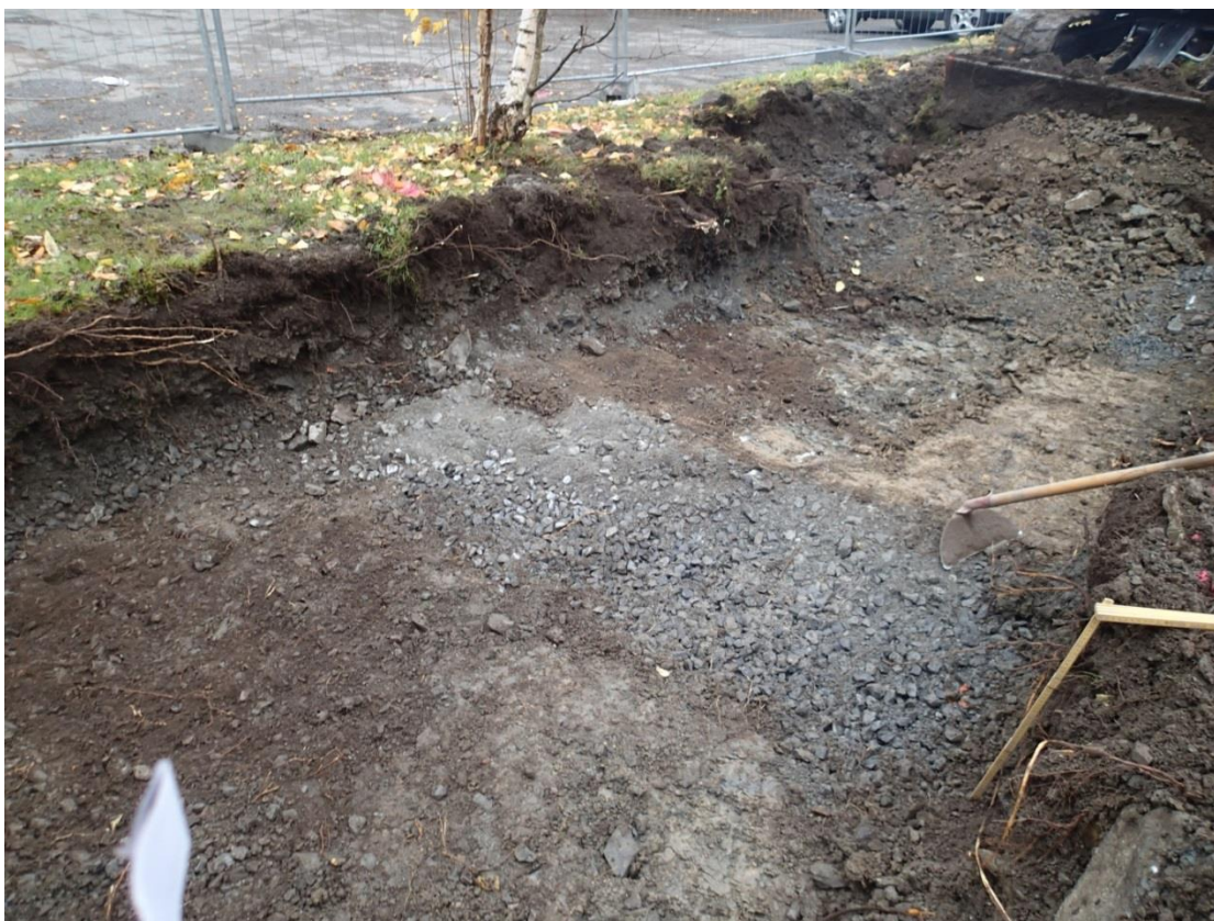
Figur 78 - Moderne, grusfylt grøft avdekket i søndre sjakt. Denne grøften var synlig i georadardataene under parkeringsplassen, men ikke i det gressbevokste området. Bilde tatt mot sørvest. Foto: Byantikvaren.
