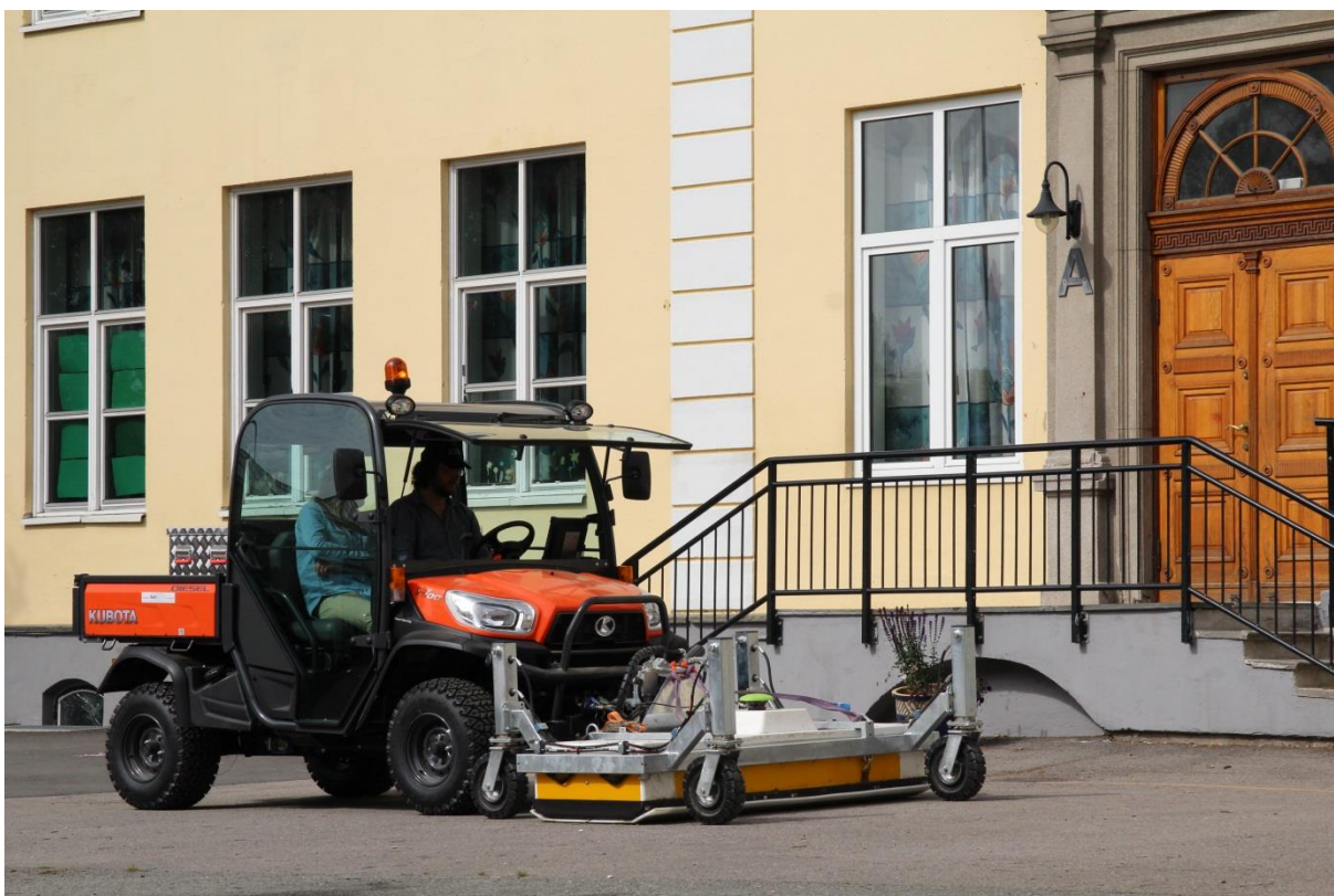
Figur 4 – MALÅ MIRA motorisert georadarsystem i bruk ved Bygdøy skole. Foto: LG/NIKU.
