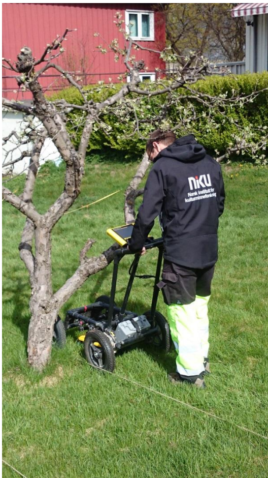
Figur 81 - Hindring i form av et frukttr e med lave greiner. Til tross for at trestammen ikke dekker et område p a mer enn noen f a desimeter, g j or de lave greinene det vanskelig  a passere med utstyret. Dette kan for arsake hull i datasettet p a inntil en meter. Foto: KP/NIKU.
