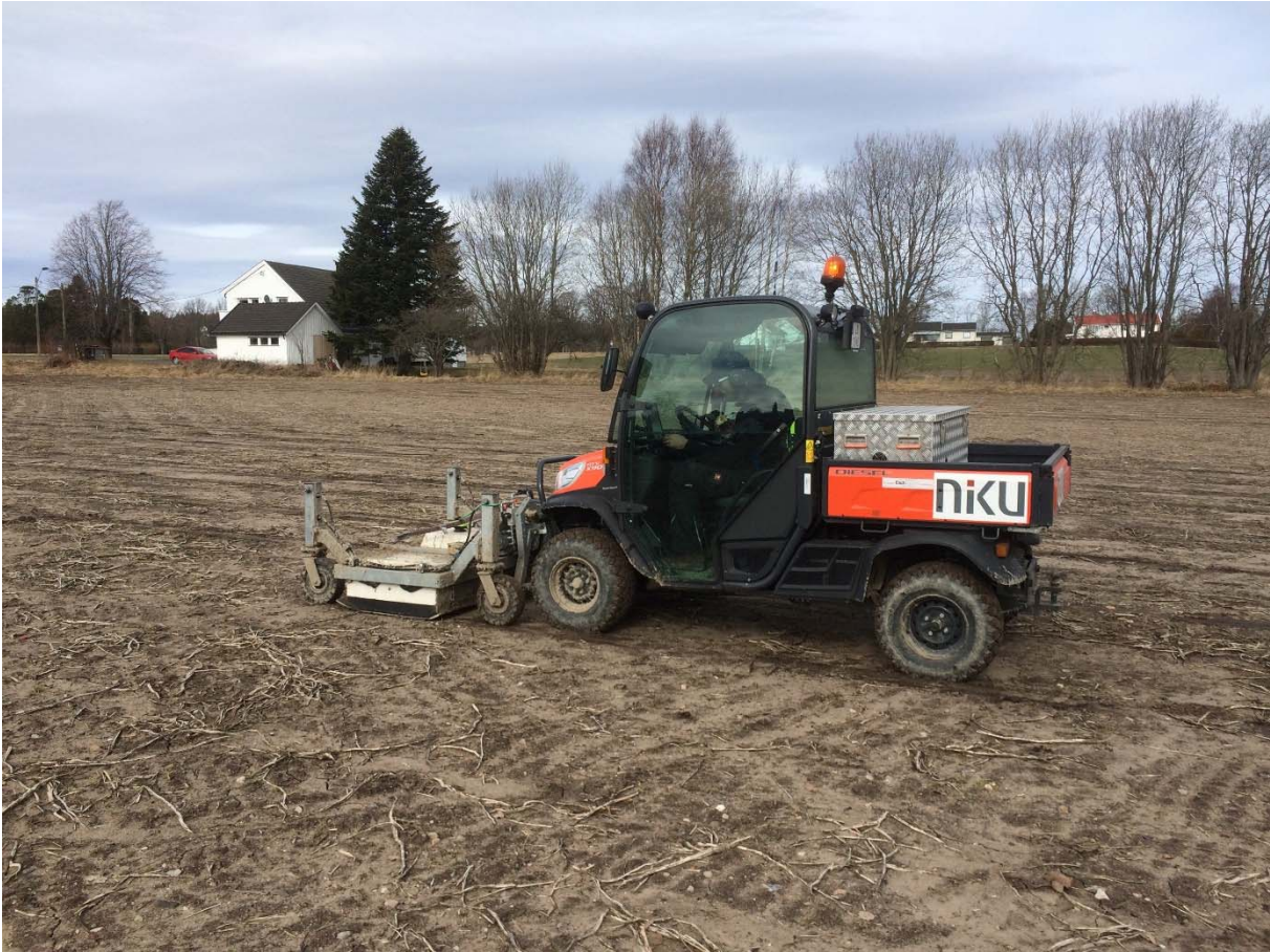
Figur 3: MIRA 3 på Lillejordet. Foto viser MIRA box innfor Kubota RTV. JAVAD RTK GPS er montert på toppen av MIRA box. Foto: MK/NIKU
