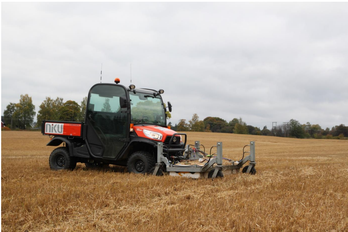
Figur 2 – MALÅ MIRA georadarsystem i bruk ved gården Gyrod.
