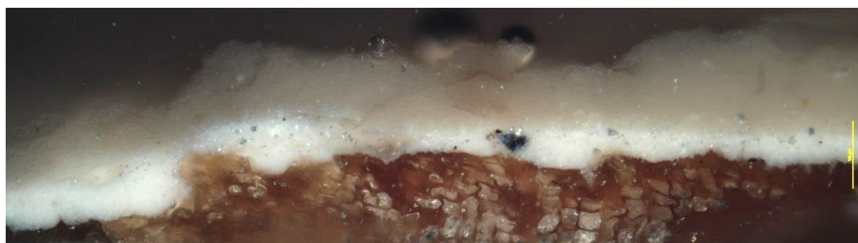
Figur 13 VB11 Ramme varevindu, materialprøve 6 (delt), 10x.
