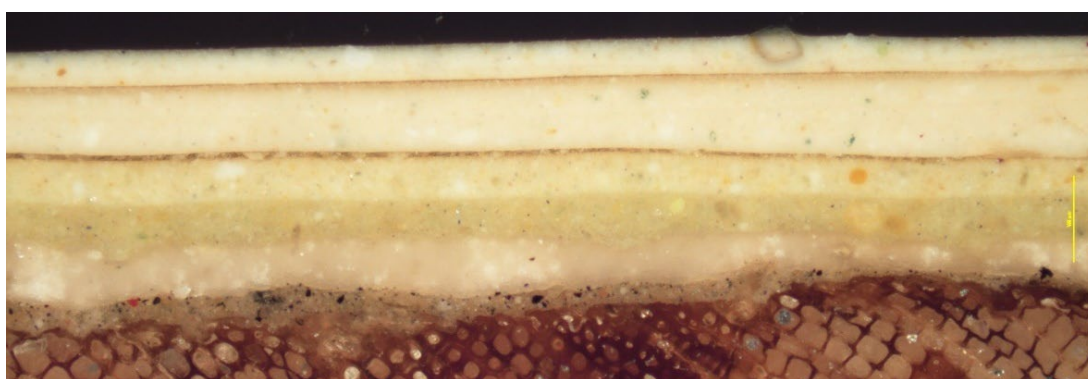
Figur 9 VB08 Gerikt, materialprøve 1 (delt), 10x. Med (delt) menes at materialprøven har delt seg i to pga dårlig vedheft mellom malingslagene. Det trengs derfor to foto for å vise malingens stratigrafi; nederste foto viser nedre del av prøven, med treverk nederst i bildet; øverste foto viser øvre del av prøven, med dagens malingslag øverst. Første overflatelag på gerikt (lyst grønnlig lag på nederste bilde) tilsvarer trolig nr. 9, L7 på karm.
