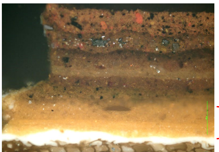
Figur 26 Til venstre: Avdekking i utvendig karm VB26. Til høyre: VB23 Karm eksteriør, materialprøve 13, 20x. To oppmalinger med gulbrunt innerst.
