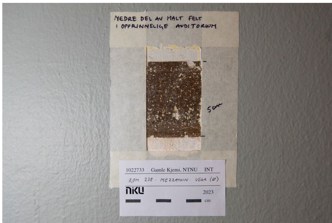
Figur 47 Rom 238. Avdekking av tidligere malt innramming av veggfelt på østveggen i det opprinnelige auditoriet. Dette er nedre del av feltet. Foto: NIKU, 2023.
