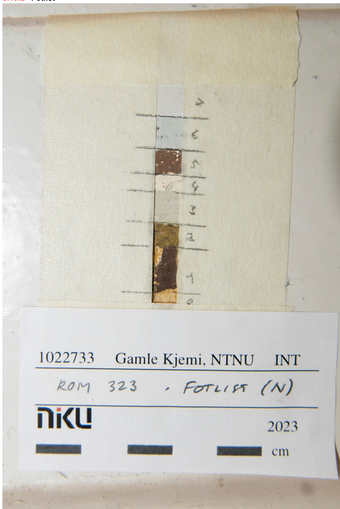
Figur 57 Rom 323. Lagvis avdekking på fotlist. Foto: NIKU, 2023.
