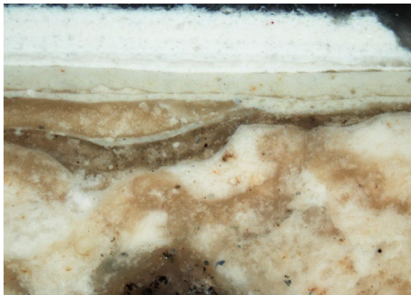
Figur 29 Tverrsnitt av alle malingslagene i vindussmyget. Fotografert med pålys. 10x. Foto: NIKU, 2023.
