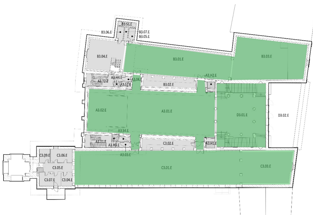
Figur 8 2023. Plantegning av etasje 03. Undersøkte rom markert med grønt (1. prioritet), gult (2. prioritet) og rødt (3. prioritet). Rom C2.01.E inngår i dag i 2. etg. Kilde: A1 - 1:200. Datering: 20.03.2023. Lund Hagem Arkitekter (NIKUs utsnitt og markeringer).
