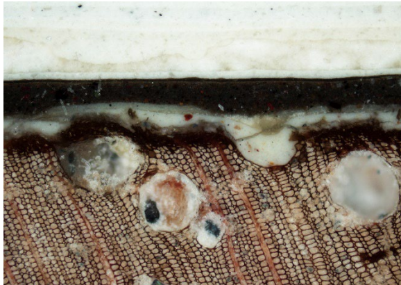
Figur 33 Tverrsnitt av de nederste malingslagene på dørbladet på dør til C4.02.E. Fotografert med pålys. 10x. Foto: NIKU, 2023.
