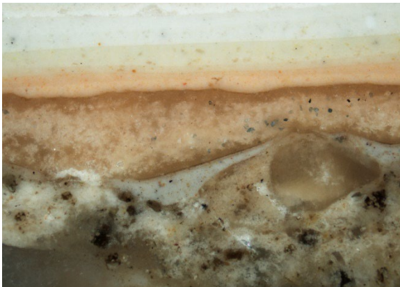
Figur 3 Tverrsnitt av de nederste puss- og malingslagene på veggen. Fotografert med pålys. 10x. Foto: NIKU, 2023.
