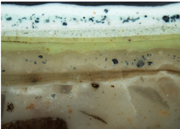
Figur 3 Tverrsnitt av alle malingslagene på veggen. Fotografert med pålys. 10x. Foto: NIKU, 2023.
