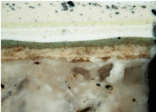
Figur 12 Tverrsnitt av de nederste malingslagene på vegg. Fotografert med pålys. 10x. Foto: NIKU, 2023.
