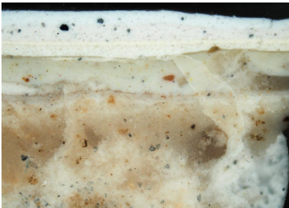
Figur 3 Tverrsnitt av alle puss- og malingslagene på veggen. Fotografert med pålys. 4x. Foto: NIKU, 2023.
