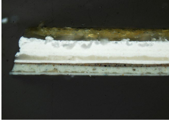
Figur 31 Tverrsnitt av de nederste malingslagene på dørgerikten på dør til C4.02.E. Fotografert med pålys. 10x. Foto: NIKU, 2023.
