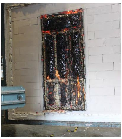
Foto 11: Branneksponert side av dørkonstruksjonen ved fjerning fra ovnen etter test.
