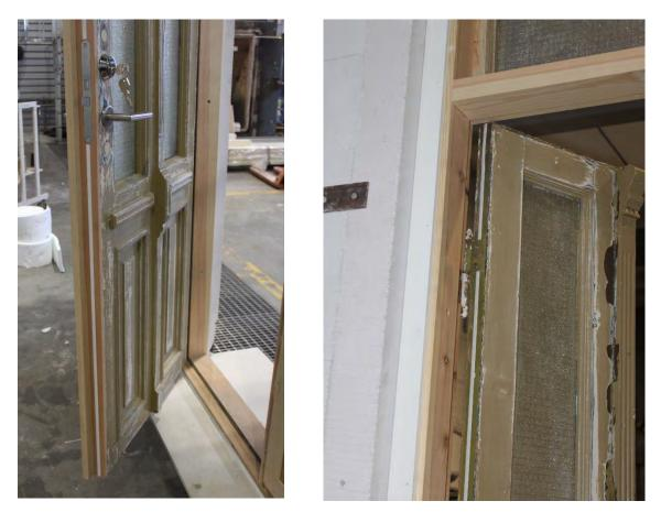
Foto 4: Bildene viser innfelt volumøkende list på sidene av dørblad samt sort tetningslist i karm.
