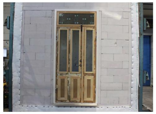
Foto 6: Eksponert side av dørkonstruksjonen før test.
