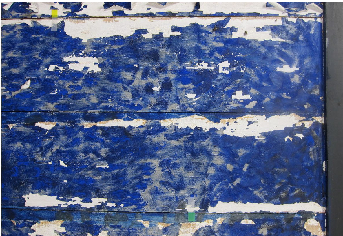
Figur 6 Testfelt for 2% metylcellulose i vann/etanol 1:1 etter konsolidering i 2022.
