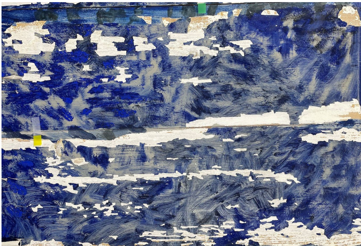
Figur 3 Testfelt for 1:1 (3% störlim i vann : 2 2% metylcellulose i vann: etanol) etter konsolidering i 2022
