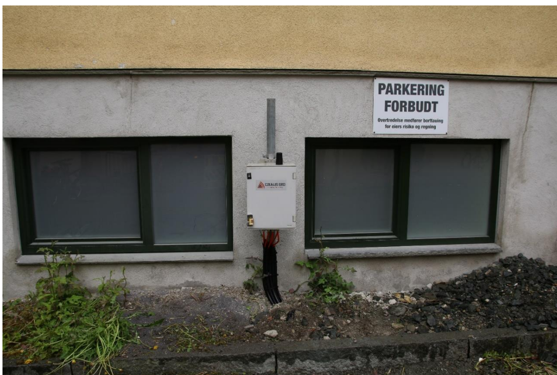
Figur 5: Målesensorer i miljøprofil 1 er koblet til skap med datalogger, som ble festet på stang støpt i betong og plassert på nabotomten. Sett mot vest. Foto: Da64649_0005.
