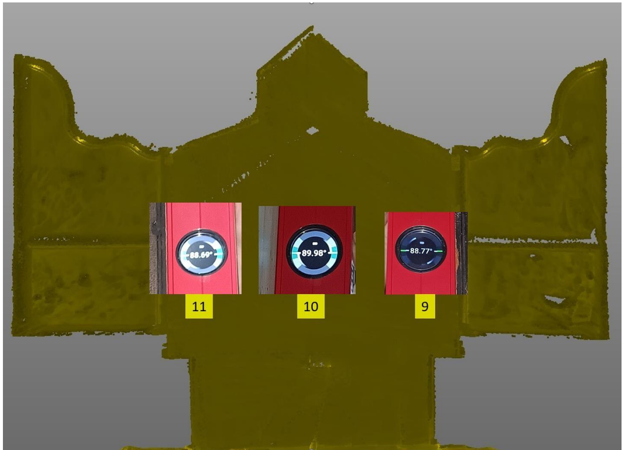
Figur 23. Viser hvor vatermålinger på skapets fremside er utført. Bildene er ifra måling 3. Numrene i gul boks på bildet viser til tallene i Tabell 2.
