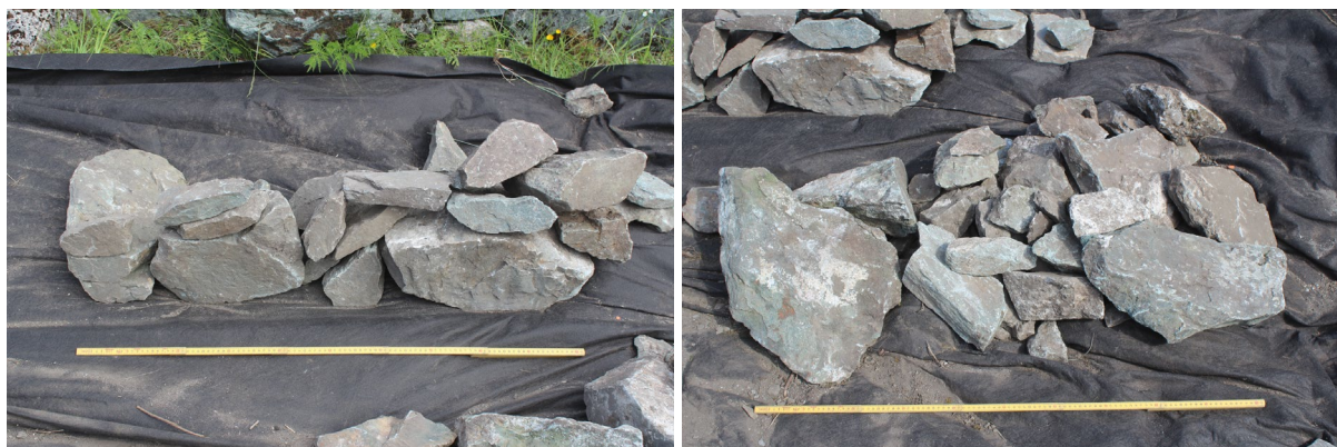
Figur 7A Steiner med form som har vært godt egnet i et murskall med vissider og mulighet for binding inn i murverket (Foto RM\NIKU 17.06.2016). Figur 7B Steiner mer mørtelspor. Kun en mindre del av steinmaterialet hadde slike spor, trolig fordi vannet i brønnen har vasket ut kalken i mørtelen (Foto RM\NIKU 17.06.2016).
