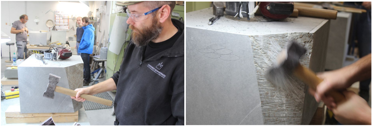
Figur 24A Espen Sørburø (NDR) holder bredhakken, et av de vanligste redskapene når man bearbeider kvadersteiner med diagonalhugging. Figur 27B Diagonalhugging med bredhakke. Først ble det hugget med bredhakken vinkelrett på steinflaten, så med bredhakken mer skrått i forhold til steinflaten.
