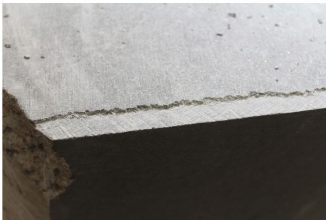
Figur 23 «Slaget» på steinen som hugges med meisel (eventuelt med hakke) for å rette opp siden på et emne. Etter at siden er rammet inn med «slag» langs hver kant hugges steinmassen i mellom til et jevnt nivå.
