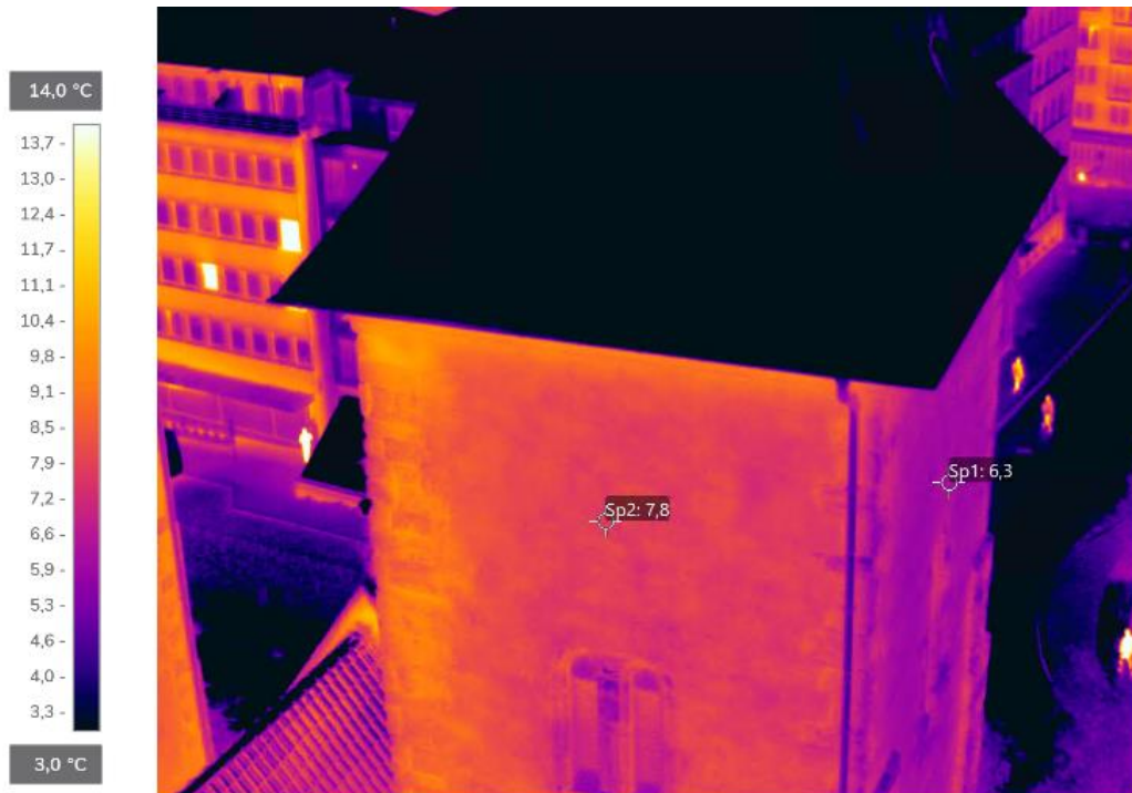
Figur 27 viser temperaturen mellom vest og nordveggen i nordretårn i Mariakirken. Sett mot VSV.
