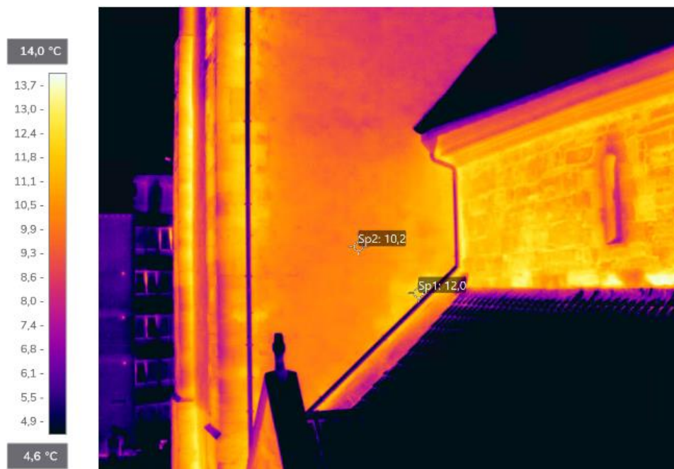
Figur 21 En lokal temperaturforskjell på østsiden av det sørlige tårnet. Figur: J. Causevic. Sett mot V
