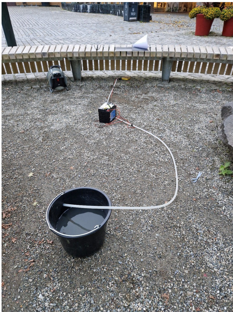
Figur 2.2 Tømming av brønn OB1 høsten 2022.
