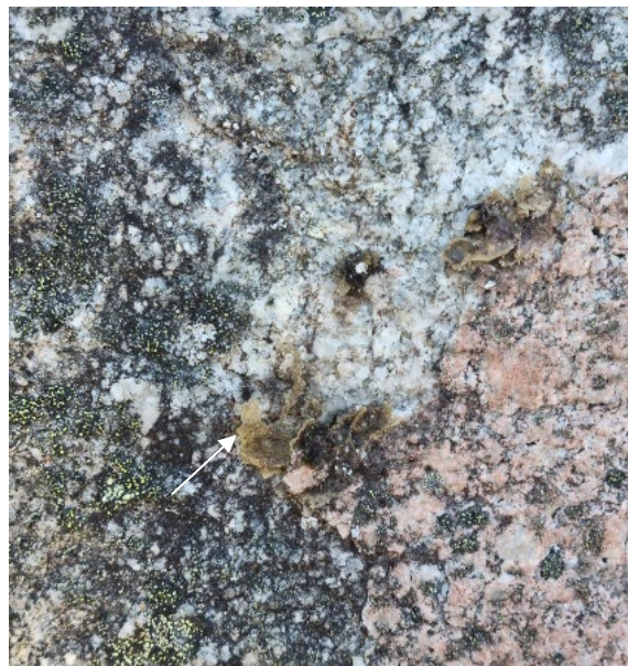
Figur 14 Konsolideringsmiddel (rester av injisert lim) ligger eksponert der løs bit har falt av. Testfelt i tilknytning til felt VIII. Foto: Karen Mengshoel, NIKU.
