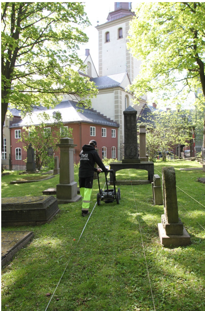
Figur 3: Kjøring med georadar på Krist kirkegård. Linjene på bakken er kjørelinjer som georadaren føres langs. Riktig posisjonering av radarprofilene er svært viktig for et godt resultat. Foto: MK/NIKU.
