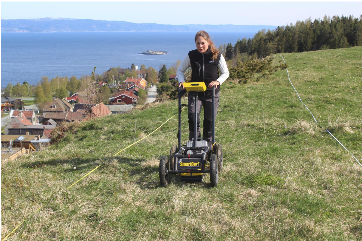
Figur 2 Monica Kristiansen (NIKU\Oslo) med enkanals 500 MHz georadar på Sverresborg (Foto RM 11.05.2016).
