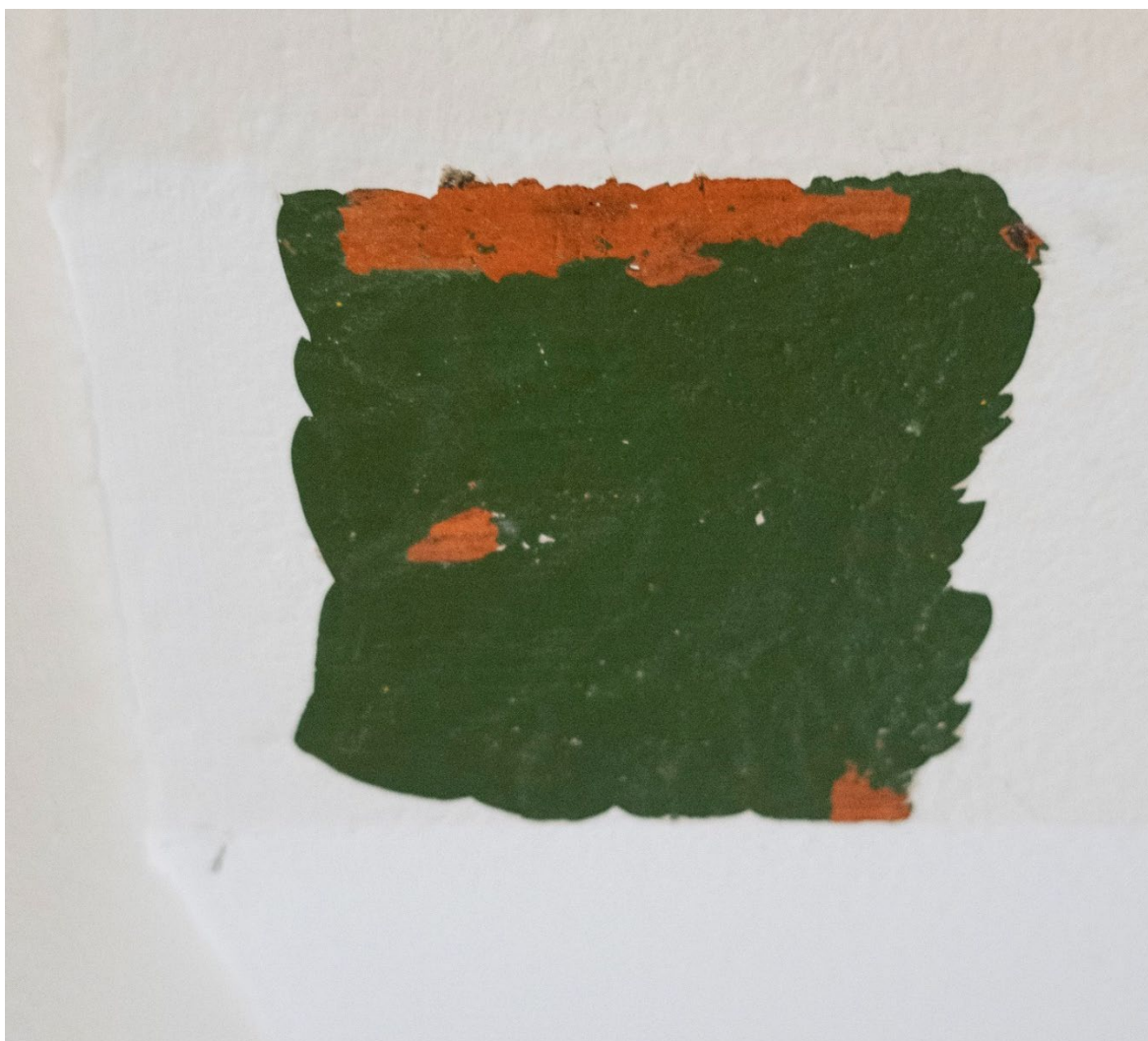
Figur 33 Rom 123. Avdekking av de tidligste malingslagene på stålbjerkene mellom buene i himlingen . Foto: NIKU, 2023.
