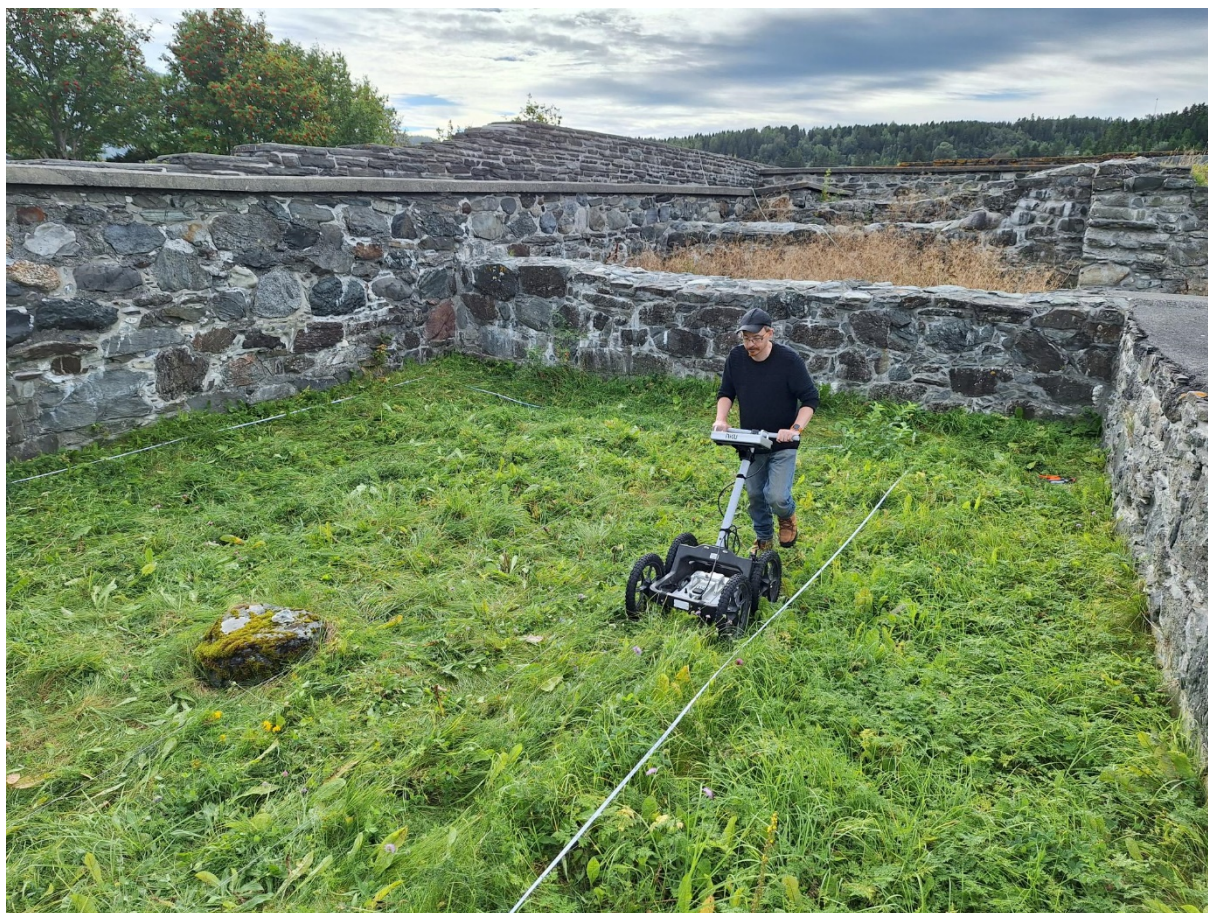
Figur 2: Dag-Øyvind Engtrø Solem med georadar av type Malå GX450MHz i Steinvikholmen. Foto: MG, NIKU.
