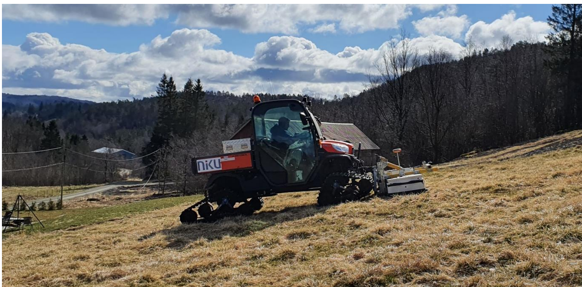
Figur 12: Motorisert georadar av type MIRA i Høyland. Operatør: Jani Causevic. Bilde: Manuel Gabler, NIKU.
