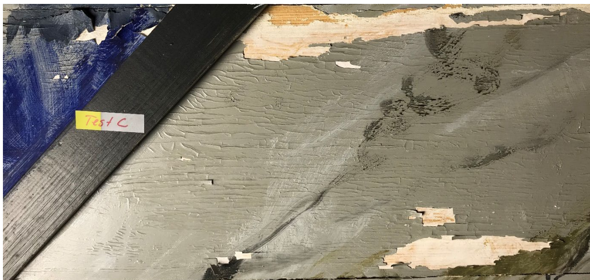
Fig. 3 Testfelt C i område med ådring, konsolidert i juni 2021 med Aquazol 200 5% i etanol. Bildet viser tilstanden i oktober 2022. Det er ny løs maling flere steder og relativt store malingsflak har løsnet fra underlaget.
