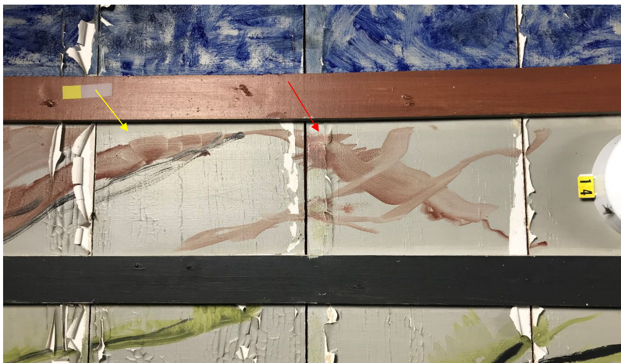
Fig. 10 Testfelt for 2% metylcellulose i vann/etanol (1:1) etter fjerning av løs maling, men før konsolidering. Rød pil viser bordet der kun de oppskallinger som sto i stor vinkel ut fra taket eller hadde lagt seg i krøll ble fjernet. Gul pil viser bordet der mer oppskallende maling ble fjernet, og kun løs maling som lå relativt flat over bunnmaterialet ble bevart.
