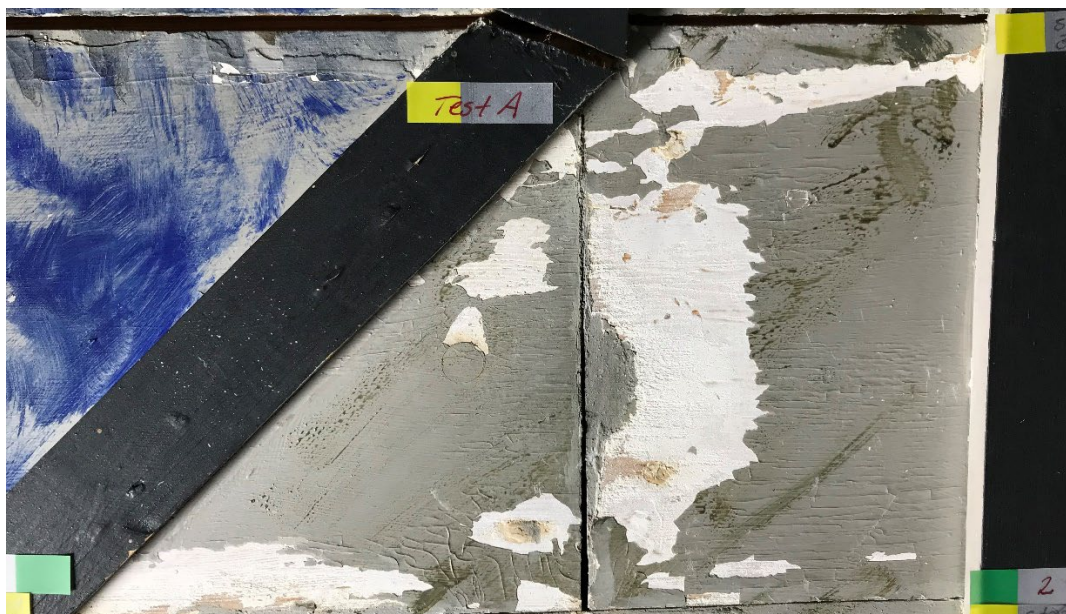
Fig. 1 Testfelt A i område med ådring, konsolidert i juni 2021 med 2% metylcellulose i vann: etanol (1:1). Bildet viser tilstanden i oktober 2022. Malingen har god feste. Konsolideringsmidlet har imidlertid ikke kunnet trenge inn under malingen i områder der det er bom under små lukkede takformete oppskallinger.
