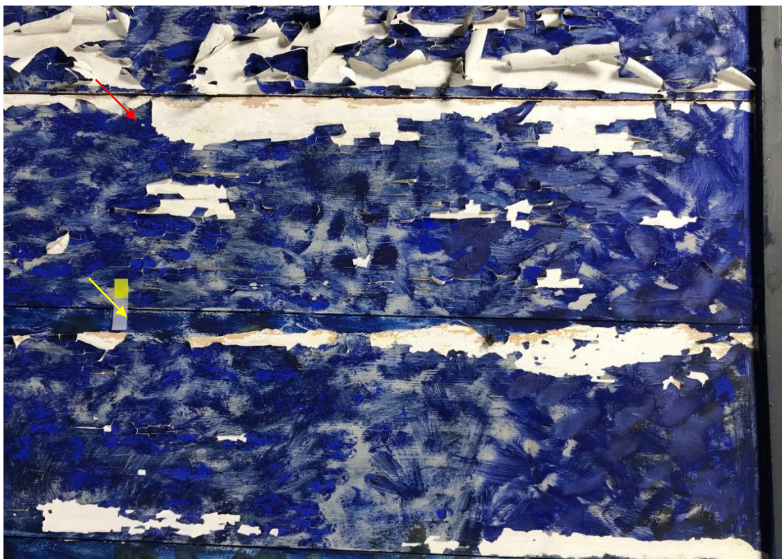
Fig. 7 Testfelt for 2% metylcellulose i vann/etanol (1:1) etter fjerning av løs maling og før konsolidering. Rød pil viser bordet der kun de oppskallinger som sto i stor vinkel ut fra taket eller hadde lagt seg i krøll ble fjernet. Gul pil viser bordet der mer oppskallende maling ble fjernet, og kun løs maling som lå relativt flat over bunnmaterialet ble bevart.
