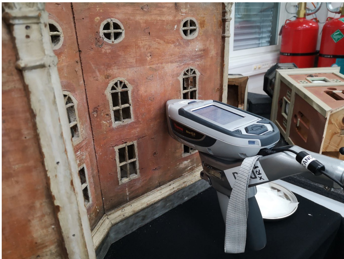
Figur 18 Elementanalyse med håndholdt XRF. Den røde veggmalingen inneholder bly, og er trolig mønje.
