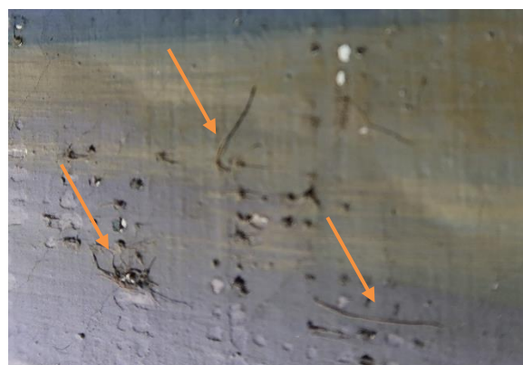
Figur 50. Detalj fra maleriet av Moses. Flassende maling og fiber fra strien som dekket maleriene i 1907.
