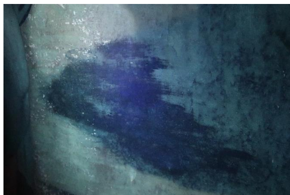
Figur 25. Detalj av område med overmaling (mørkt felt) som ligger over fluorescerende ferniss.
