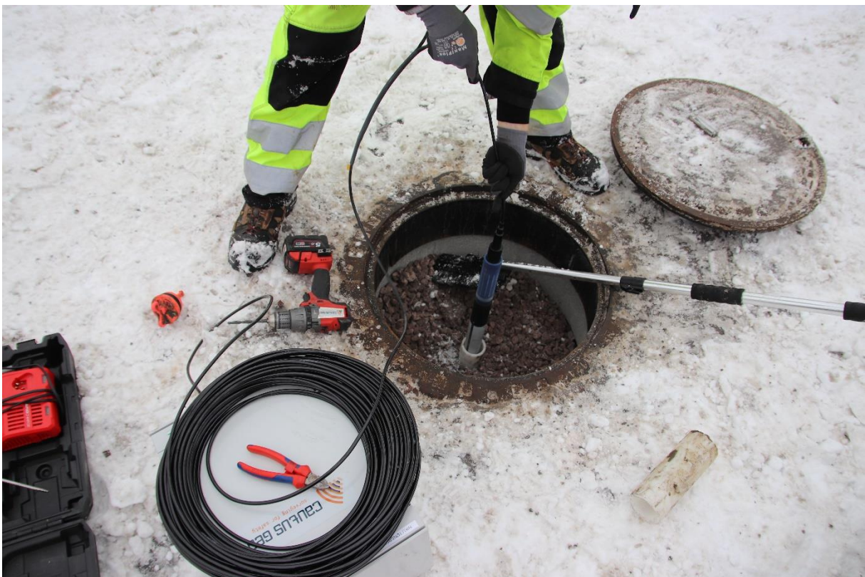
Figur 23 Nedsetting av probe Cf53518_NIKU_0085.jpg
