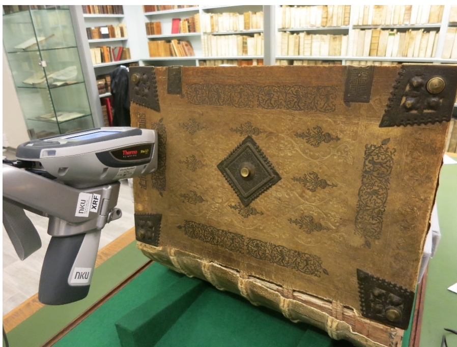
Figur 1: hhXRF-undersøkelse av innpreging på bokens innbinding
