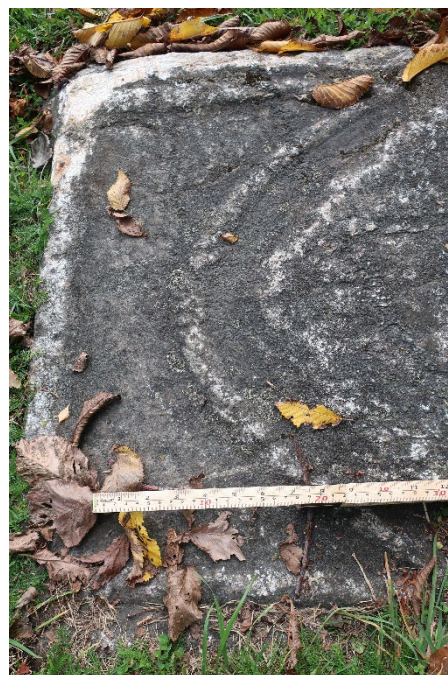
Den lyse marmorplaten er omfattende dekket av en svart skorpe som har oppstått på marmorens overflate pga kjemisk reaksjon mellom steinens kalkholdige komponenter i et surt miljø.
