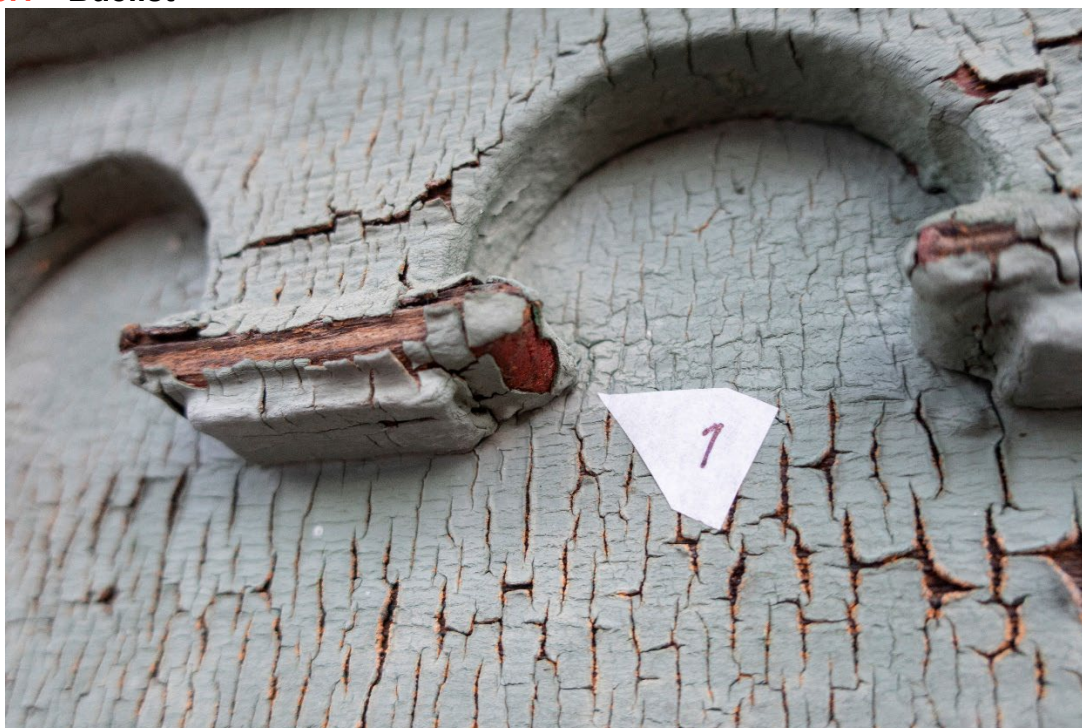
Figur 12 Prøve til tverrsnitt tatt på buelisten. Treet er ikke med i prøven. Pilen viser plassering av uttaksted. Foto: NIKU, 2022.
