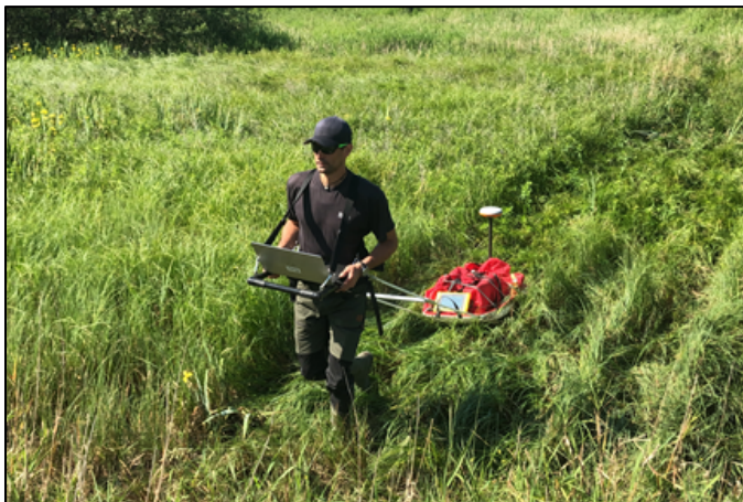
Figur 16. Bruk av georadar i våtmarksområder, foto Monica Kristiansen.
