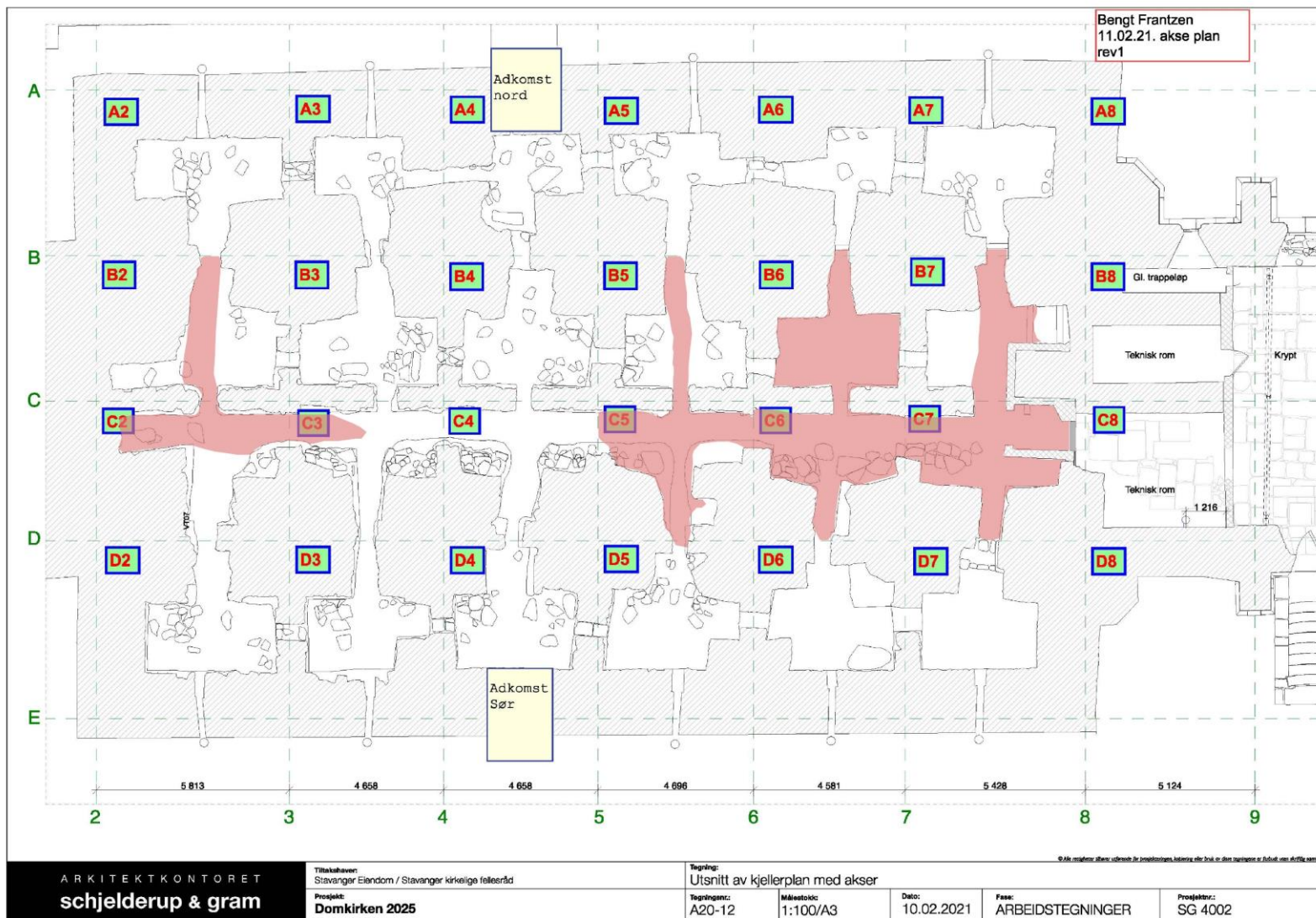
Figur 6. Akseplan over krypkjellerens kammerinndelinger. Områder hvor opprensede masser ikke ble såldet, er markert i rosa.
