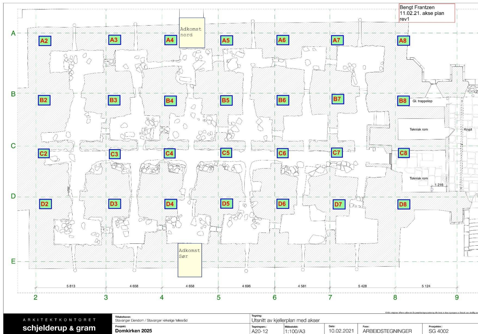
Figur 2. Akseplan over benevnelser på krypkjellerens kammerinndelinger. Feltenes benevnelse står i feltets øverste venstre hjørne. De samme hjørnene i akse B og D markerer også søylens benevnelse. Illustrasjon ved tiltakshaver.
