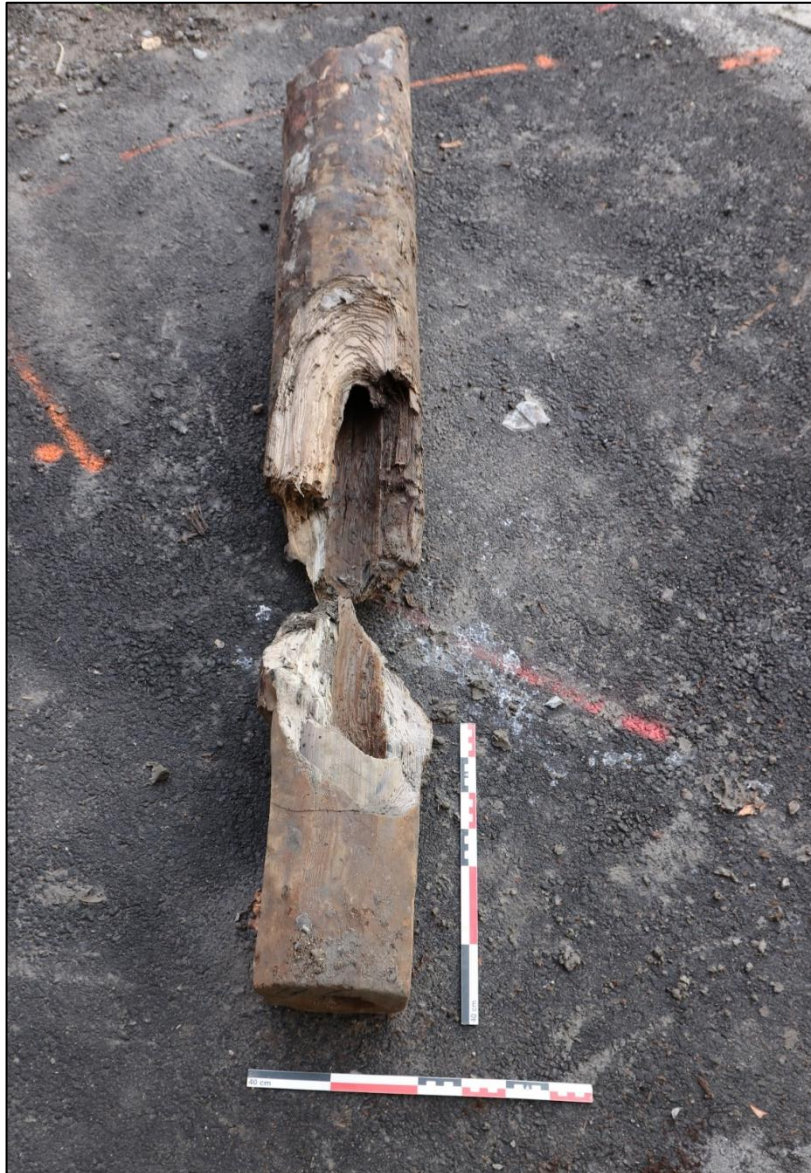
Figur 18. Bilde CF53873_NIKU_0170 som viser en uthullet stokk funnet løs i massene ved SA1830. Intren dimensjon av gjennomgang var 50 mm. Stokken ble tatt være på av Skien kommune ved vannverksmuseet.
