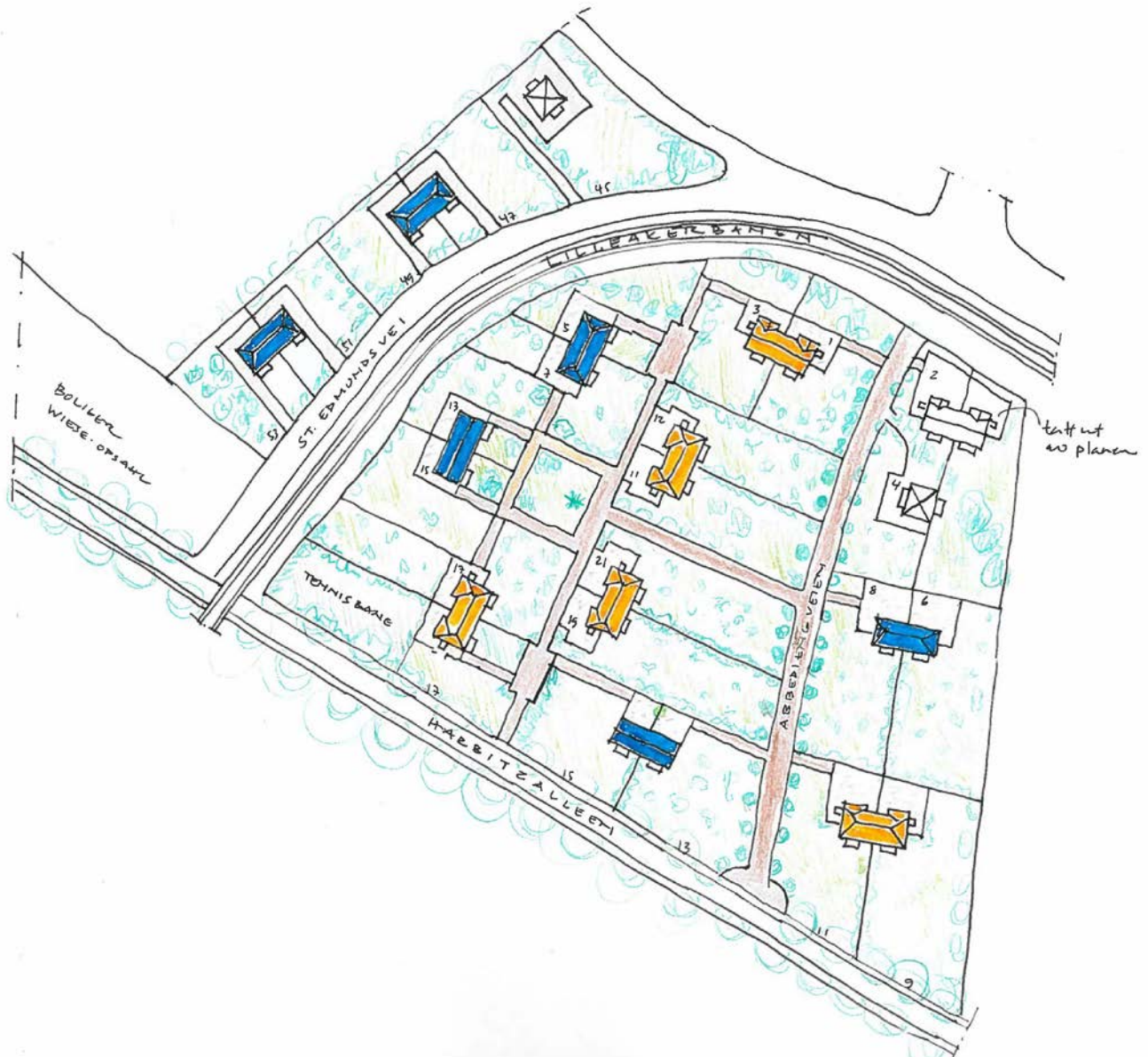
Figur 10 Hagebyens planfigur med adkomstforhold og bebyggelsesstruktur. Tegningen viser plassering av dobbelthusene midt i tomtegrensene - og de ulike typene – farge blå: type 1, farge oransje: type 2.
