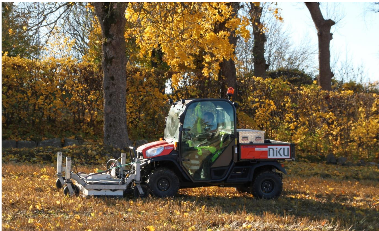
Figur 6 - Motorisert, flerkanals georadarsystem av typen MALÅ MIRA. Foto: EN/NIKU.
