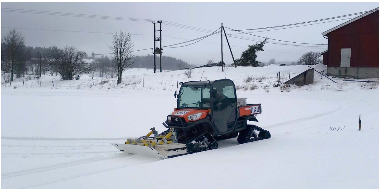
Figur 5: Georadarsystem av typen MALÅ MIRA, montert på en beltedrevet Kubota RTV X900. Foto: LG/NIKU.
