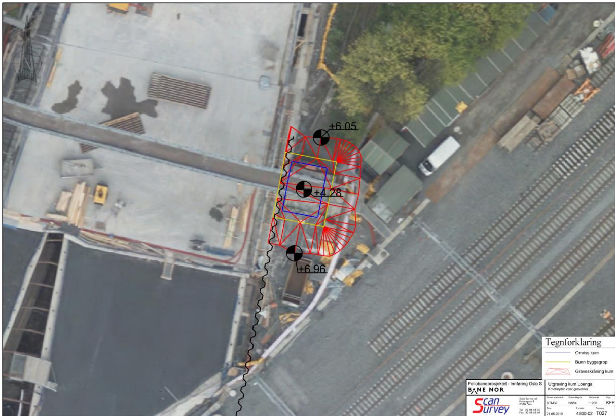
Figur 2: Byggegrøp for kum C i den nordre enden av kabelføringsrøret, med angitt kote for gravedybden til byggegropen. Graveskråning er merket med rødt. Illustrasjon: Bane NOR SF.
