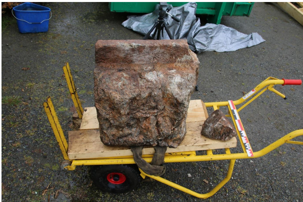
Figur 104. Utsiden av bygningsstein F6425. Fargen og overflaten viser tydelig varmpåvirkning. Bildet viser bygningsdelens innside, slik den var plassert opprinnelig. Fragmentet som ligger ved siden av steinen ble funnet i samme område, og er fra den skadde endeflaten. Målestokken er 50 cm. Foto fra fotogrammetrisering av bygningsstein F6425. Bildet finnes ikke i musit.
