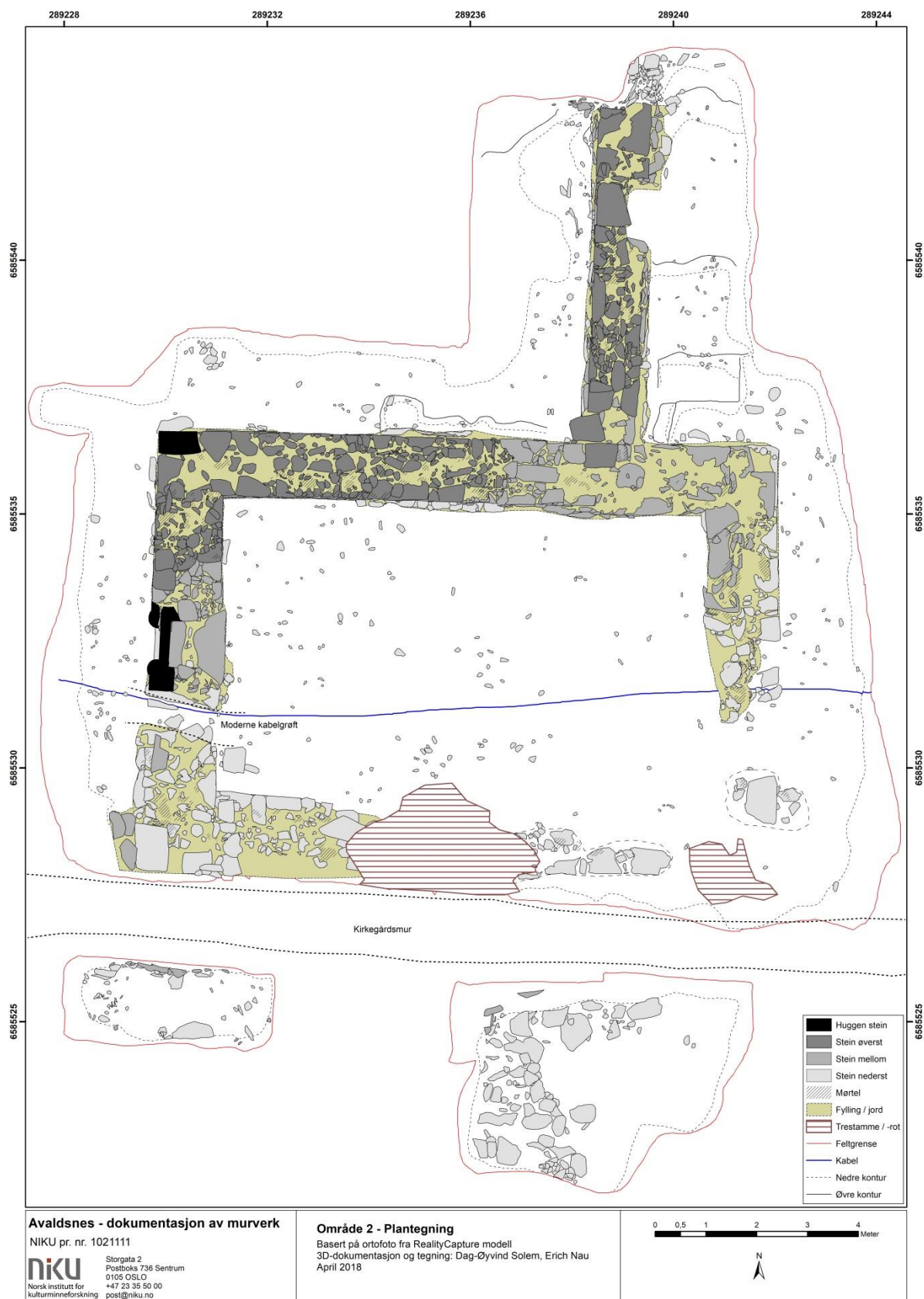
Figur 16. Tegning av SA10 (tårn) og SA30 (forbindelsesmur mot Olavskirken) basert på dokumentert situasjon etter utgravingen i 2017. Sokkelen kommer frem enkelte steder, i søndre del av vestmuren til SA10 (på utsiden), og midt på nordmuren. Det meste av sokkelen til SA30 er synlig her. Nord er opp. (Hentet fra Nau og Solem, 2018).
