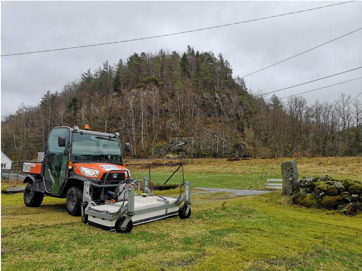
Figur 11: Motorisert georadar av typ MIRA i Sira. Operatør: Jani Causevic., Bilde: Manuel Gabler, NIKU.
