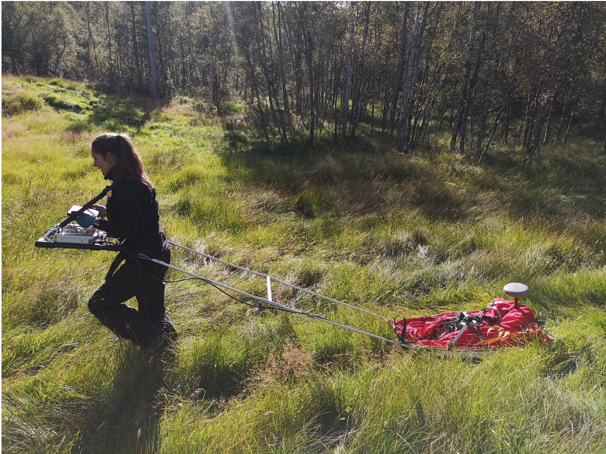
Figur 12: Georadarsystem for myr og våtmark. Operatør: Monica Kristiansen. Bilde: Manuel Gabler, NIKU
