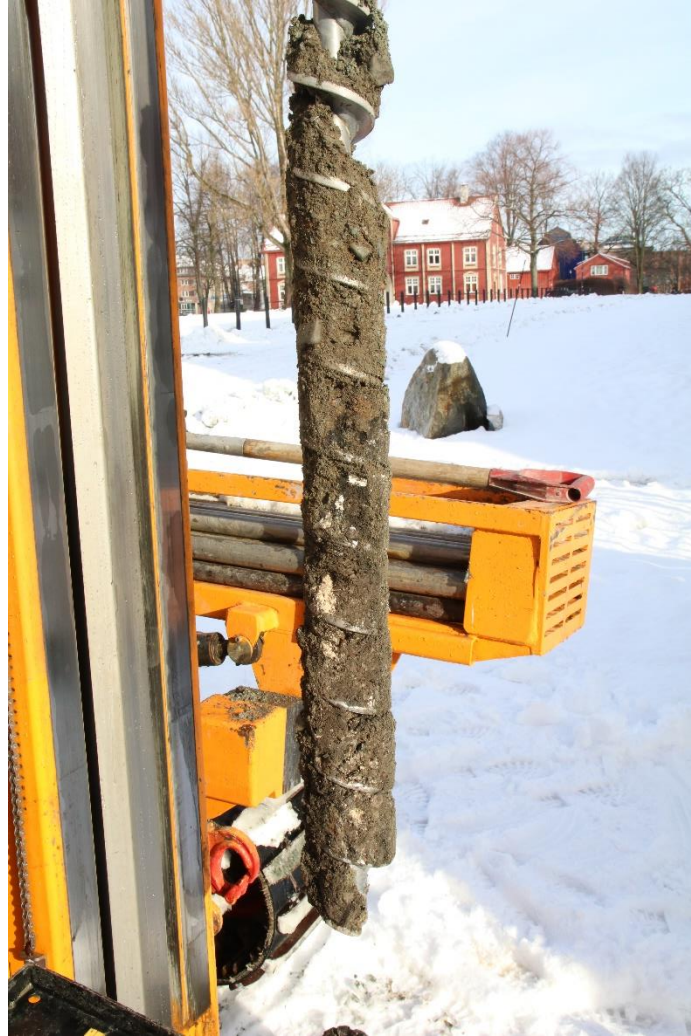
Figur 3. Boreprøve 2, 0-1 m. Flekker av mørtel i massen. Da62847_004.
