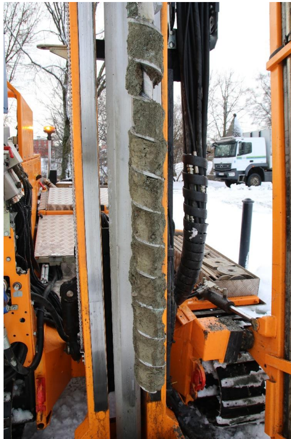
Figur 2. Boreprøve 1, 1-2 m. Rasleire i søylen. Da62847_002.
