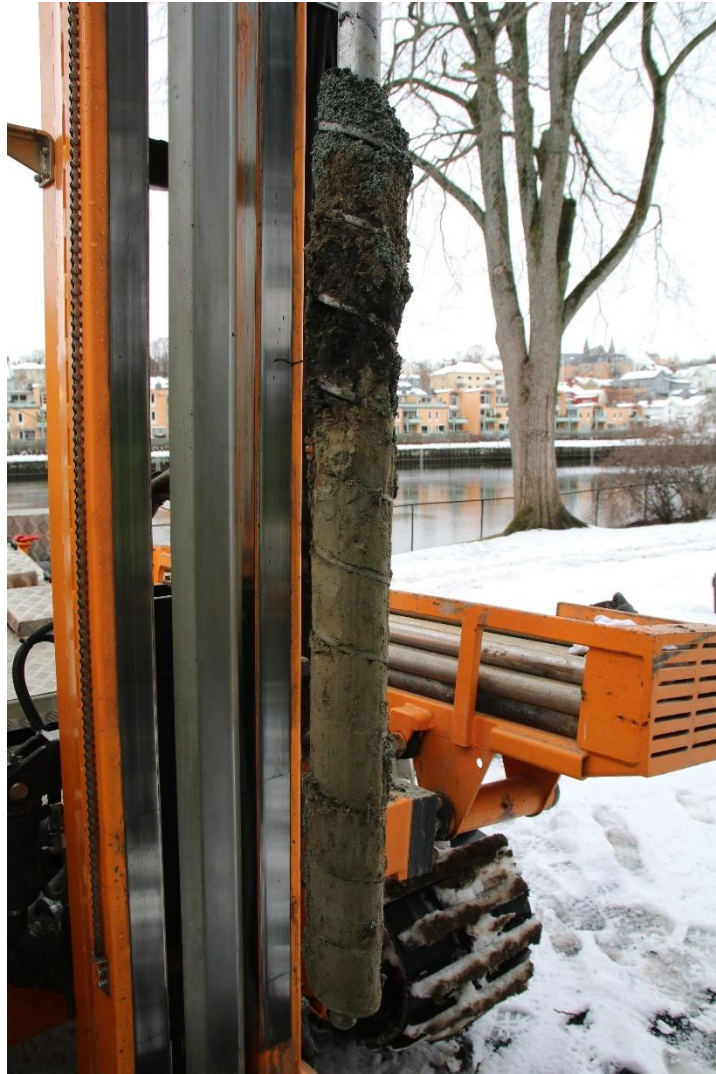
Figur 4. Naturlig undergrunn i boresøyle 47, 0-1 m. Da62847_006.
