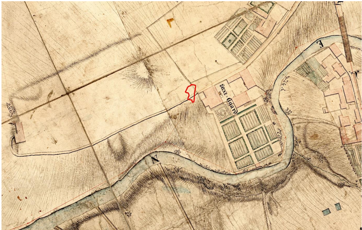
Figur 12 Situations-Plan No. 2. Over Allun Wærket og en Deel af Opsloe (1779) , orientert mot nord. Merk oppmålingslinjene i rødt. Kartet er ment å leses på skrå fra venstre, hvilket gjør mange (men ikke alle) av høydeforskjellene lesbare. Det er dermed tydelig at terrenget faller sørover fra veien vest for Saxegården, og tynne linjer viser at det stiger igjen til en rygg parallelt med Alnaelva. Lenger mot vest er det tydelig at det stikker ut et lite fremspring fra nivå med veien, med bratte skrenter ned mot elva. Utgravningsområdet er markert i rødt.
