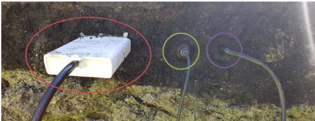
Figur 6. Nærbilde av vanninnhold-, pH- og redokssensor
