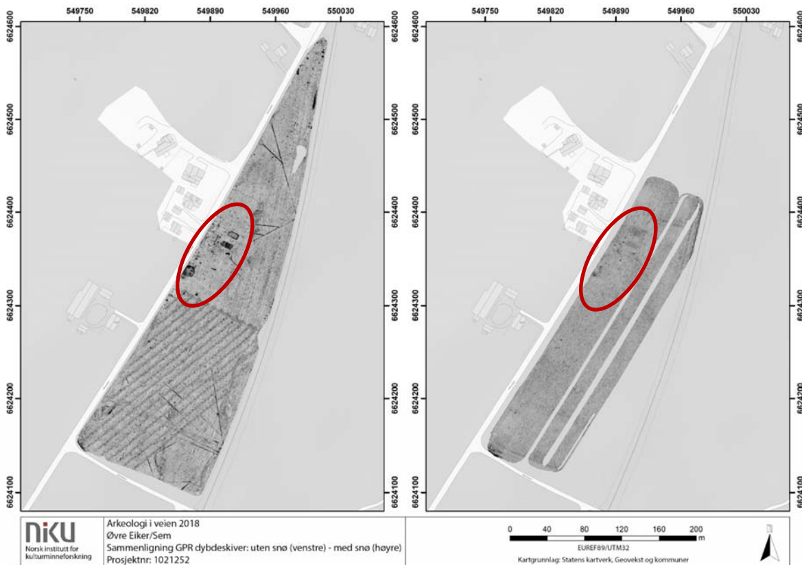
Figur 18. Sammenligning av GPR dybdeskiver uten snø (venstre) og med snø (høyre). Resultatene viser ingen arkeologiske strukturer på snøføre, enda de er veldig tydelig synlig på undersøkelser uten snø.
