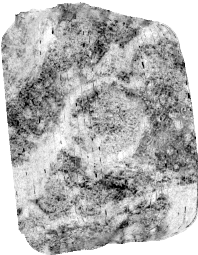
Figur 12. GPR dybdeskiver fra Odberg med snø fra 2018. Resultatene på snøføre viser et mindre klart bilde enn fra 2007. Allikevel kan man klart identifisere arkeologiske strukturer i dybdeskivene.
