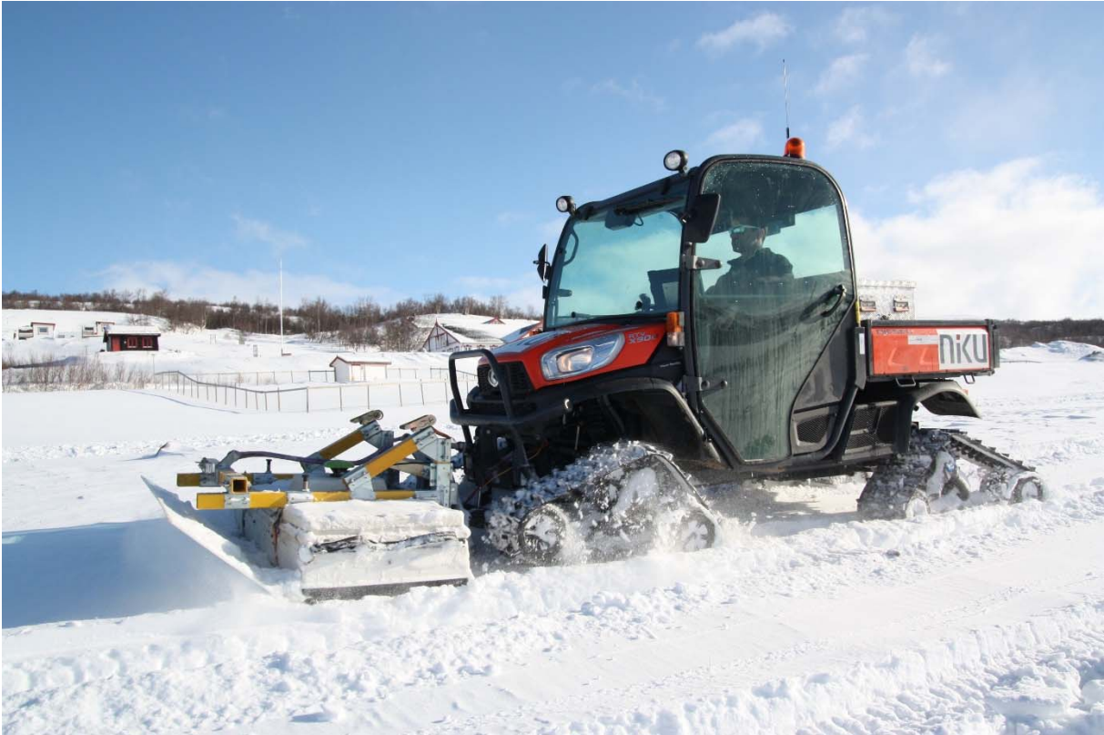
Figur 5. Georadarsystem av typen MALÅ MIRA med vinterutstyr. Foto: EN/NIKU.
