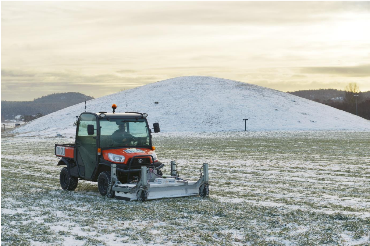
Figur 2: Motoriserte georadarundersøkelser med et radarsystem av typen MALÅ MIRA IV vinteren 2019. Foto: Lars Gustavsen, NIKU.
