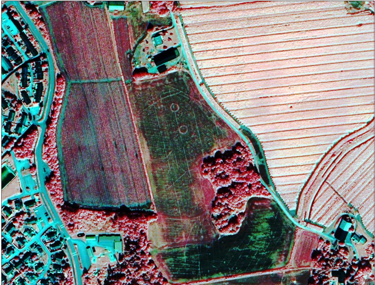
Figur 2 - QuickBird satellittbilde fra gården Guri ved Tjøllingvollen i Larvik kommune, Vestfold, tatt 7. august 2010. Bildet er histogramutjevnet for å få fremheve kontraster. Videre er de forskjellige fargebåndene kombinert slik at det røde båndet er byttet ut med det nær-infrarøde. Omtrent midt i bildet kan sees en åker med vegetasjonsspor etter moderne dreneringsgrøfter, samt to sirkulære strukturer som representerer fotgrøftene etter utpløyde gravhauger. Legg merke til at vegetasjonssporene som representerer dreneringsgrøfter ikke kan spores i åkrene rundt. Opphavsrett: DigitalGlobe, Norsk Regnesentral.
