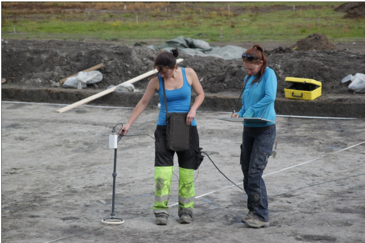
Figur 21 - Magnetisk susceptibilitetsmålinger i forbindelse med en utgraving ved Gokstadhaugen i 2012. Instrumentet som brukes er et Bartington MS2D 19 Foto: NIKU.
