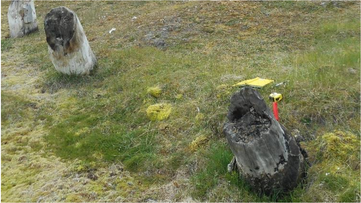
Figur 29: De tre pelene som ble undersøkt i Tuft A var sterkt nedbrutt av råte innenfra, men så relativt intakte ut på utsiden. Foto: NIKU/AC Flyen
