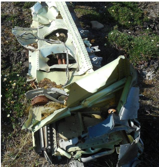
Figur 15: Korrodert jern og aluminium, til venstre i flyvraket på Hiorthhamn, til høyre i drenerør i Gamle Longyearbyen. Foto: NIKU/AC Flyen
