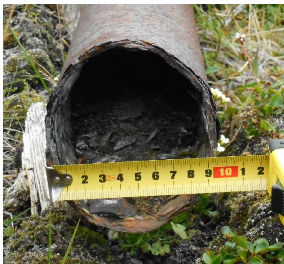
Figur 15: Korrodert jern og aluminium, til venstre i flyvraket på Hiorthhamn, til høyre i drenerør i Gamle Longyearbyen. Foto: NIKU/AC Flyen
