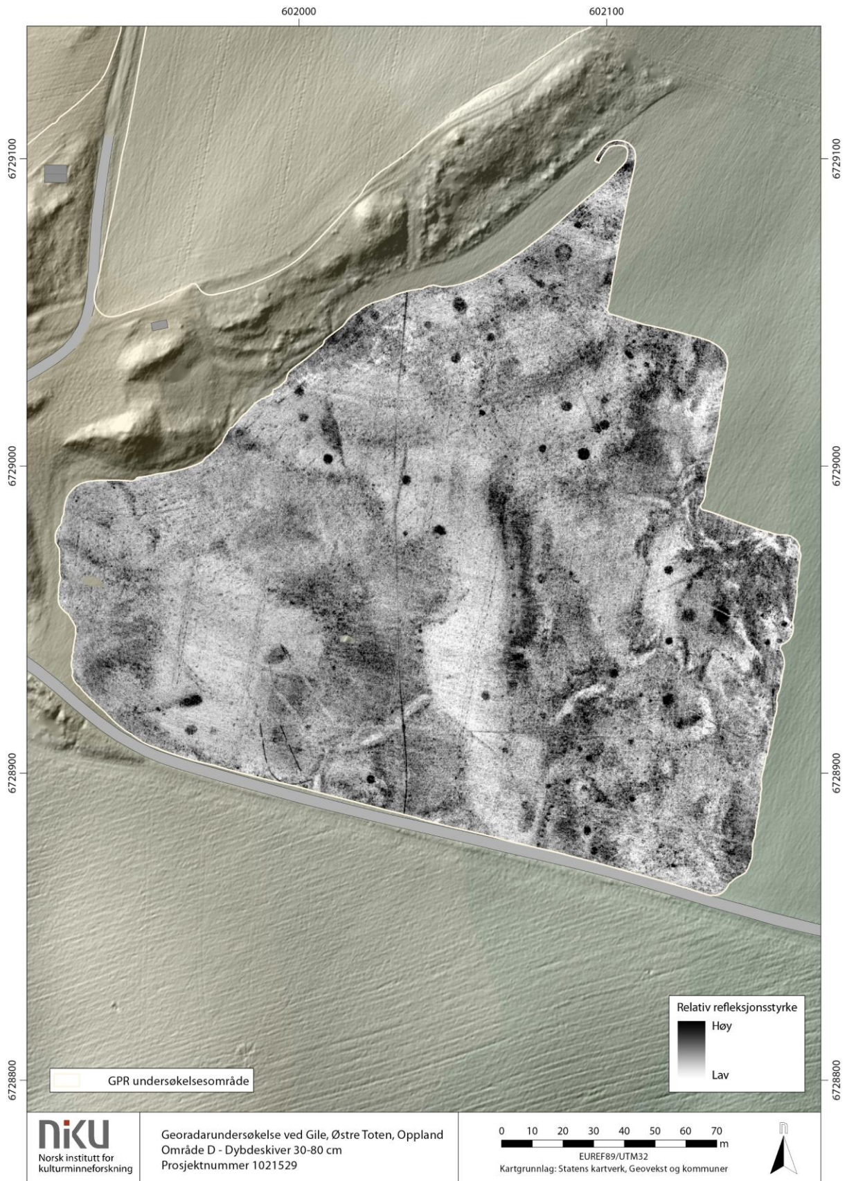
Figur 12: Område D med dybdeskive fra dybdesjiktet 30-80 cm. Legg merke til at ikke alle strukturene vises innenfor dette dybdesjiktet.
