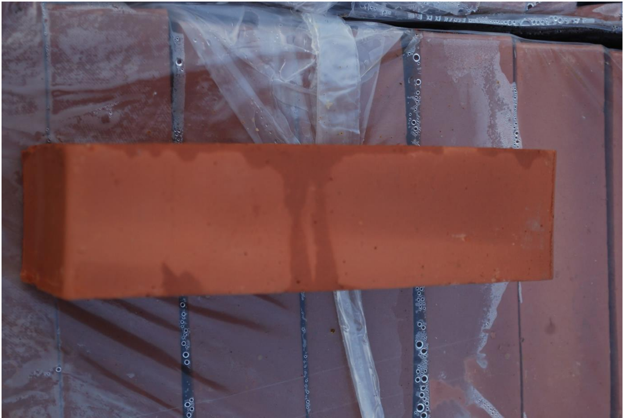
Foto: Bro II. Ny, spesialbestilt tegl som ble benyttet i teglbuen. Foto: NIKU v/AC Flyen
