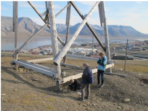
Figur 11. Montering av temperaturloggere på bukken på Skjæringa. Foto: Mycoteam AS/J. Mattsson
