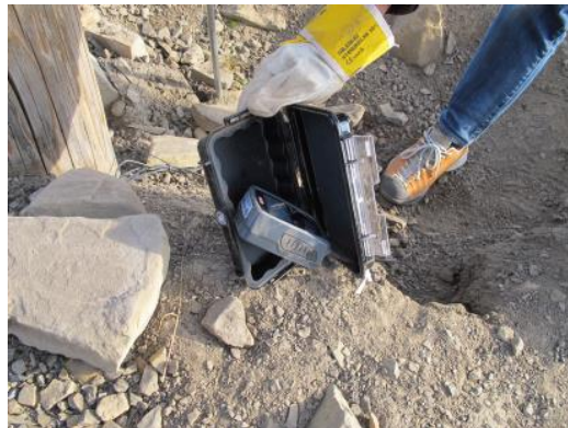
Figur 12. Temperatur og relativ luftfuktighet ble målt i bakken ved den reparerte taubanebukken. Foto: Mycoteam AS/J. Mattsson
