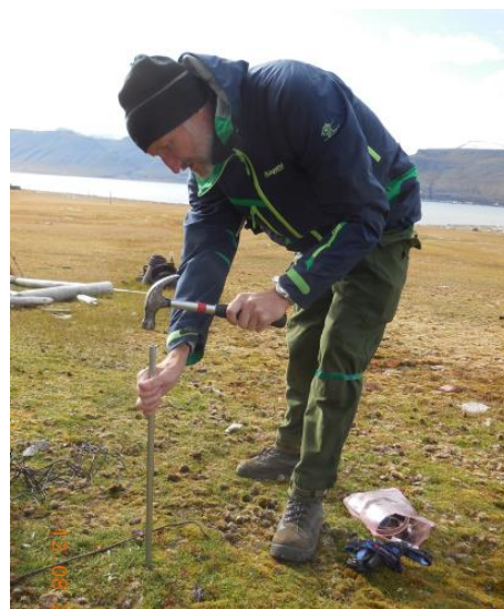
Figur 7. Trange forhold under Svenskehuset. Foto: NIKU/A.C. Flyen. Til venstre: Feltnmåling av dybden på tinesonen. Foto: Mycoteam AS/J. Mattsson
