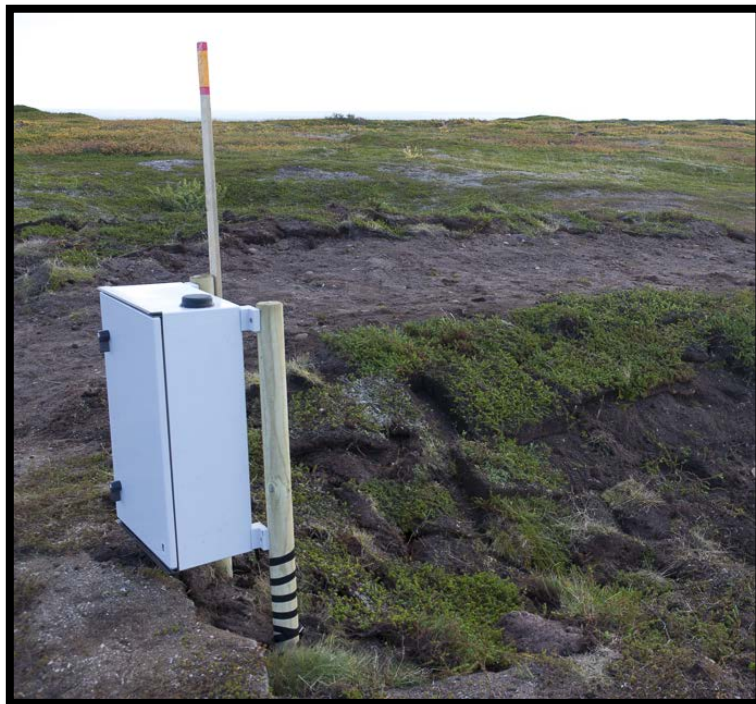
Figur 2. Området som ble overvåket etter at utgravingen var avsluttet og sjakten fylt igjen. Profilveggen som ble overvåket lå på venstre side av bildet over. (Foto: NIBIO, Ove Bergersen)
