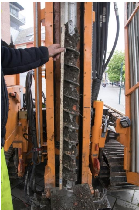
Figur 14 og 15: TP110. Bilde av andre meter og detaljbilde samme boreseksjon, med målestokk. Da61924_NIKU_29 og Da61924_NIKU_30.
