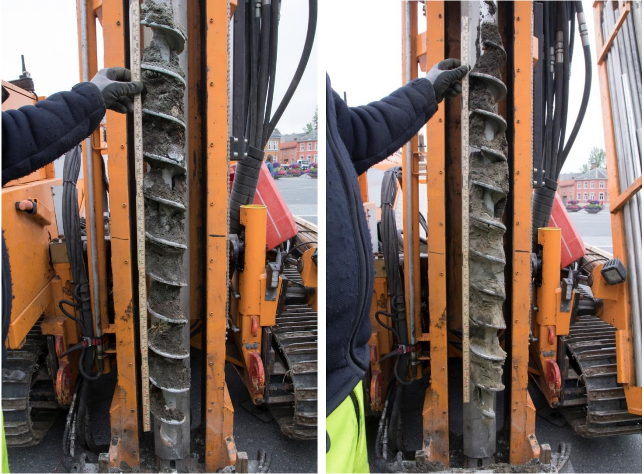
Figur 17 og 18: TP113. Bilde av andre og tredje meter av boreseksjon, med målestokk. Da61924_NIKU_26 og Da61924_NIKU_27.
