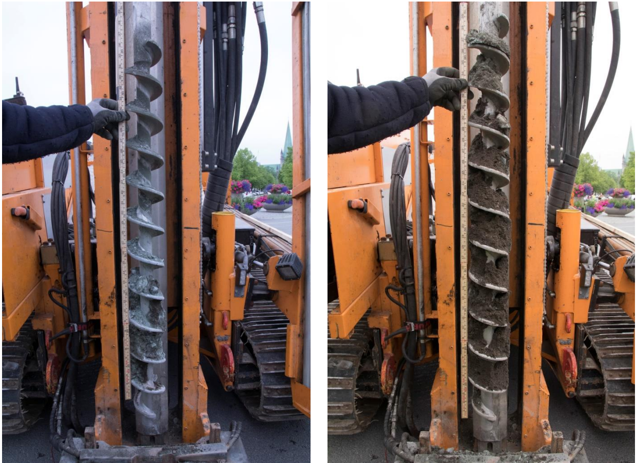
Figur 19 og 20: TP113. Bilde av andre og tredje meter av boreseksjon, med målestokk. Da61924_NIKU_22 og Da61924_NIKU_23.
