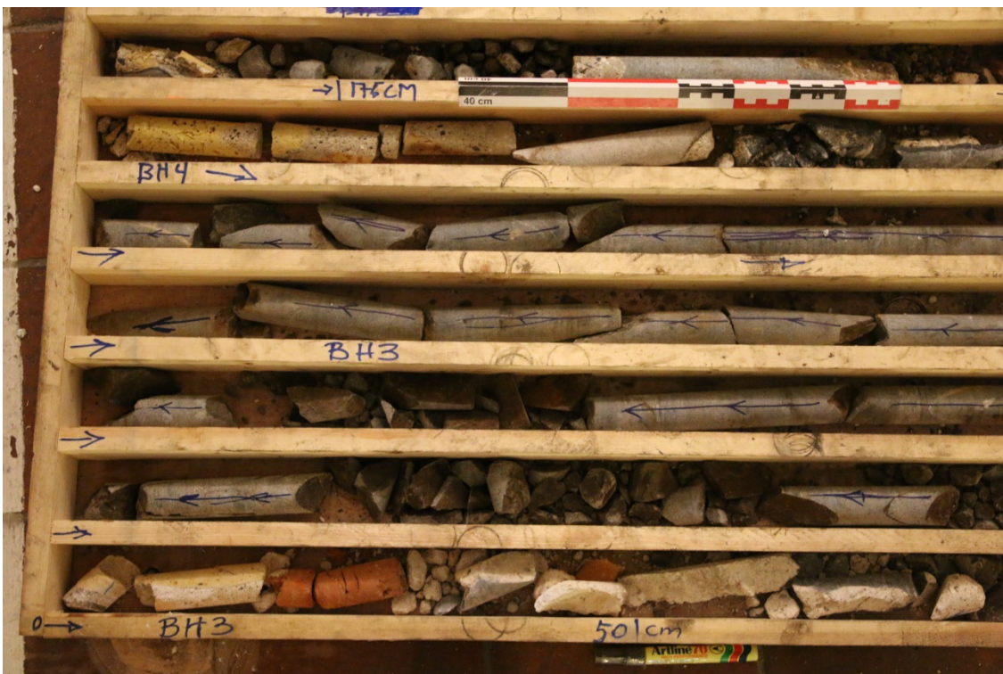
Figur 4: BH3 og BH4 i kassa. Foto av NFF. Foto-nr: Cf35274_NIKU_0022
