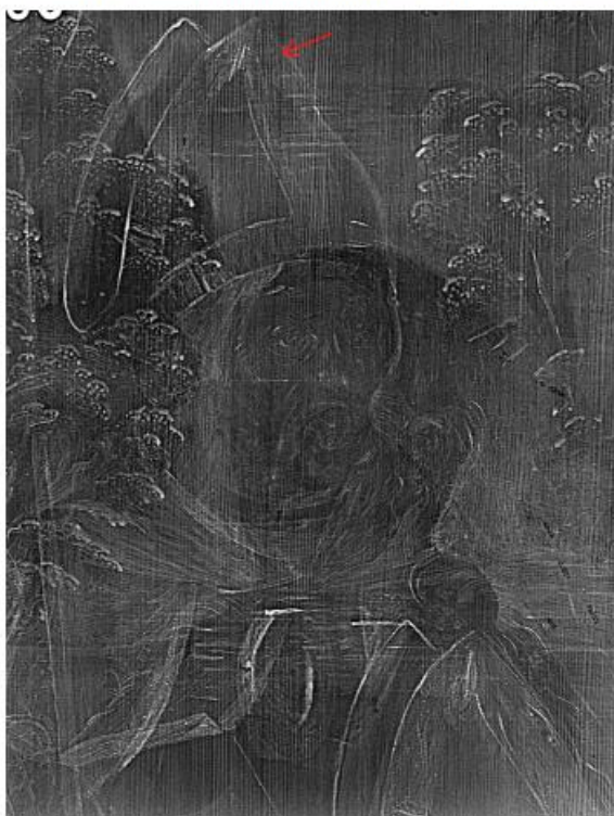
Figur 20 Røntgenbilde A 136. Detalj av øvre del av venstre fløydør. Motivene på fløydørens inn- og utside ligger i røntgenbildet opp på hverandre, slik at vi ser omrissene til både St. Maternus og St. Margaretas ansikt i røntgenopptaket. Det påfallende at de malte ansiktene absorberer i liten grad røntgenstråling. Hudfarge iblandet mye blyhvitt ville man forvente en høy absorpsjon av røntgenstråling. En slik karakteristisk høy absorpsjon ser vi kun i høylys for eksempel på biskopshatten, St. Maternus kappe, stavene, etc.
